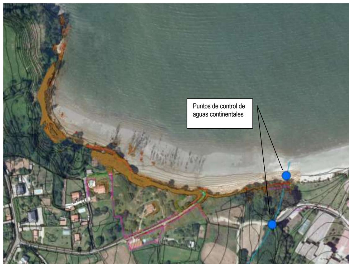
Puntos de control de aguas arriba y aguas abajo en el rego do Cabanés.
