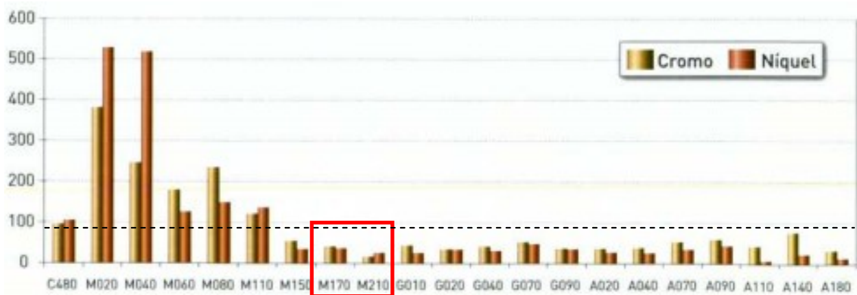
Ilustración 64. Concentraciones medias de cromo y níquel (mg/kg) en los sedimentos del litoral mediterráneo. Remarcada en rojo las muestra M170 y M210. La línea discontinua indica el valor medio del litoral. (Fuente: Consejería de Medio Ambiente).
