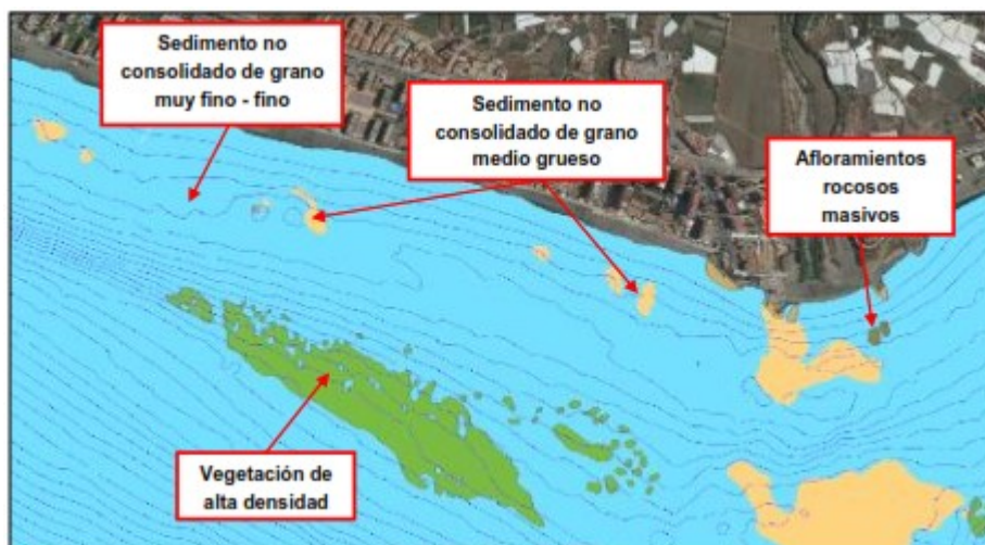
Ilustración 27. Morfología fondo marino playa Ferrara. Fuente: (Ministerio para la Transición Ecológica, Diciembre 2019).
