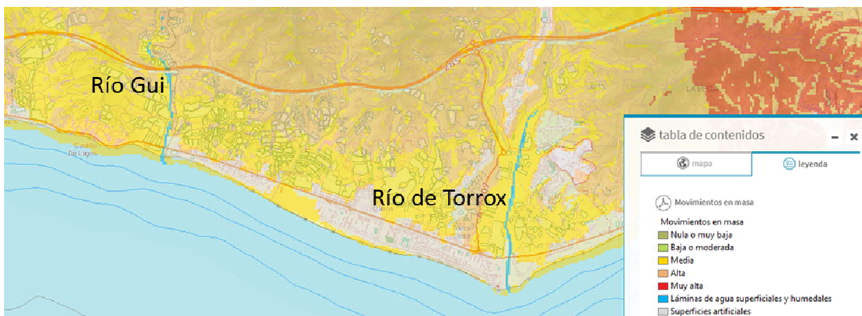
Ilustración 49. Movimientos en masa (fuente: MAGRAMA, Biodiversidad, INES Movimientos en masa).
