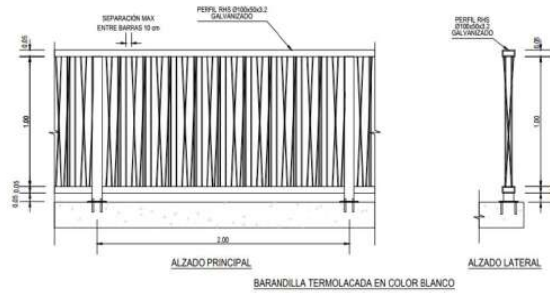
Figura 5. Definición de la barandilla metálica.
