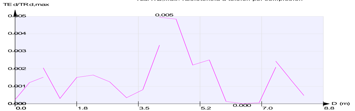
EL Rotura por torsión Situación accidental Envolvente de combinaciones Envolvente global TEd/TRd,max: Resistencia a torsión por compresión
