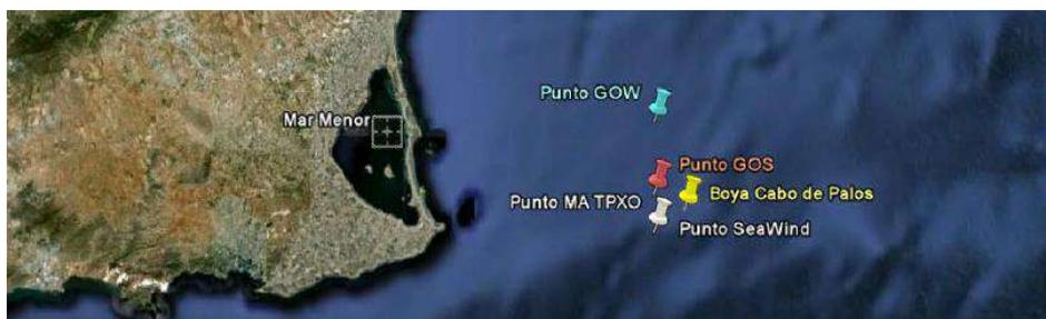
Figura 1. Localización de los puntos de reanálisis. Puntos SeaWind (Viento), GOW (Oleaje), GOS (Marea Meteorológica) y MA TPXO (Marea Astronómica).
