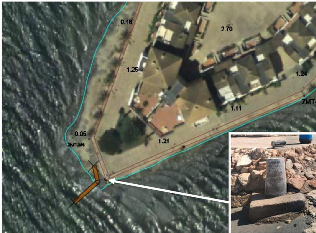
Figura 9. Embarcadero proyectado junto a Hito DP-09 (256).
