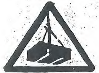
PELIGRO DE CARGAS SUSPENDIDAS
