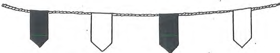
CORDON DE BALIZAMIENTO.
