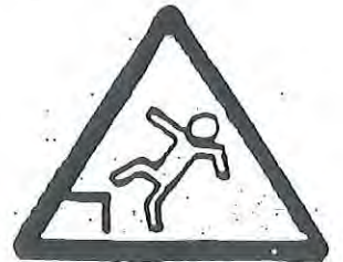
PELIGRO DE CAIDAS A DISTINTO NIVEL
