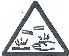
PELIGRO DE CORROSION
