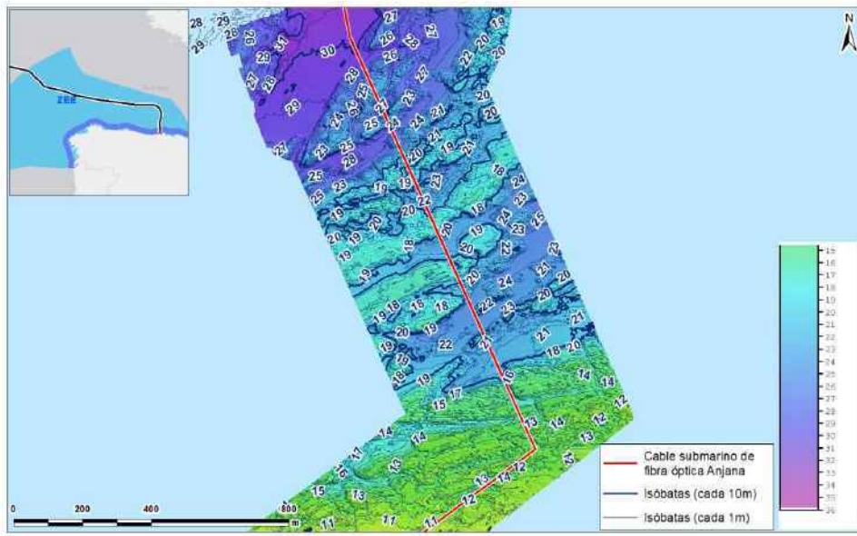
Figura 21.- Batimetría de detalle en la zona entre los 12 y los 22 m de profundidad. Fuente: elaboración propia a partir de datos de NEC.
