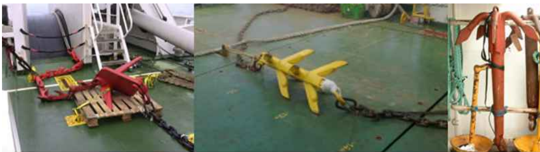
Figura 7. Típico conjunto de anclas de rezón antes de la colocación. Fuente: NEC.
