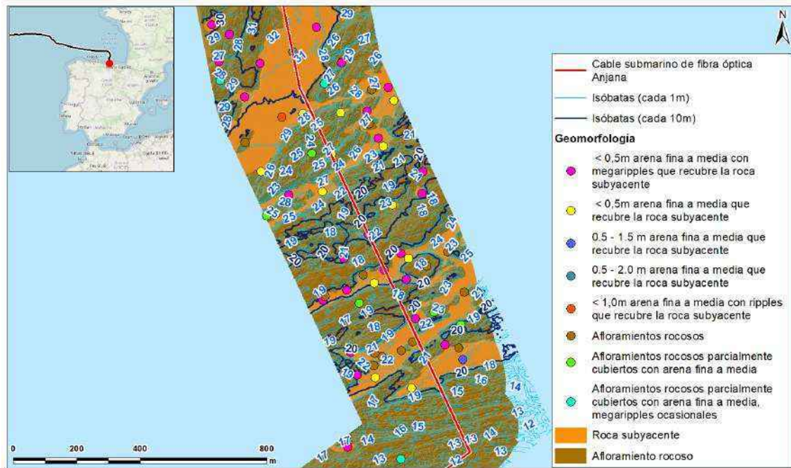
Figura 28.- Geomorfología de detalle a profundidades entre 13 y 30 m. Fuente: elaboración propia a partir de datos de NEC.
