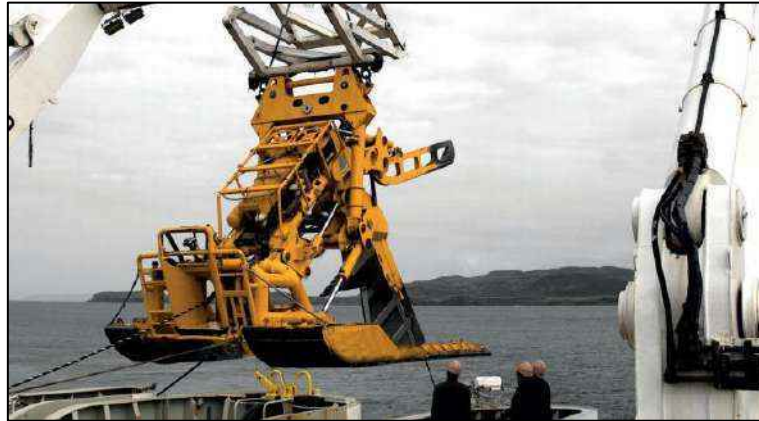
Figura 10.- Ejemplo de máquina de arado bajada en mar desde buque cablero. Fuente: NEC.
