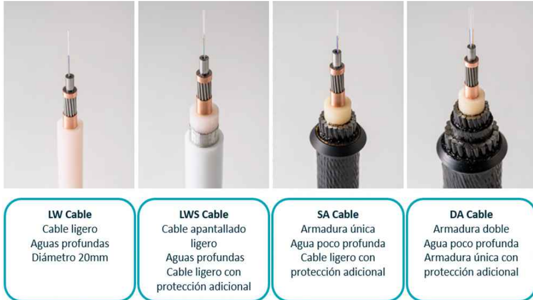
Figura 27. Tipos de cables que se emplearán en el proyecto. Fuente: NEC.
