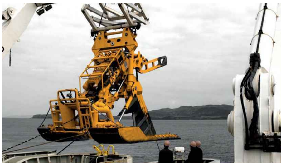
Figura 9. Arado de cable típico. Fuente: NEC. .
