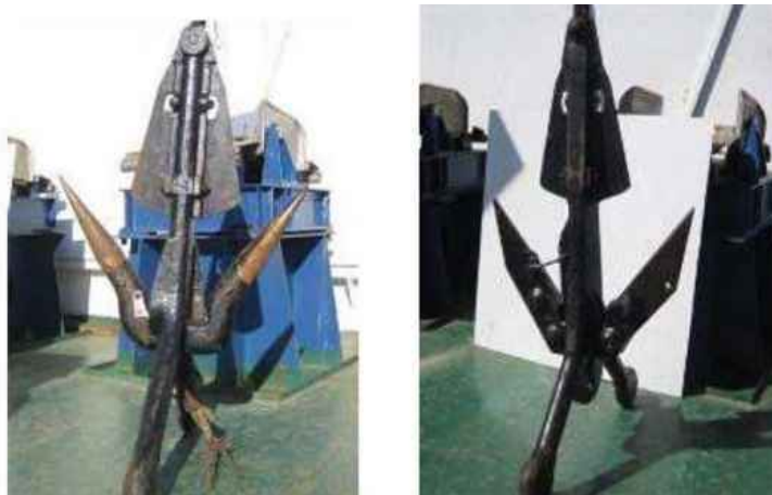
Figura 6. Ejemplos de ancla de rezón para recuperar y cortar cables dañados. Fuente: NEC.
