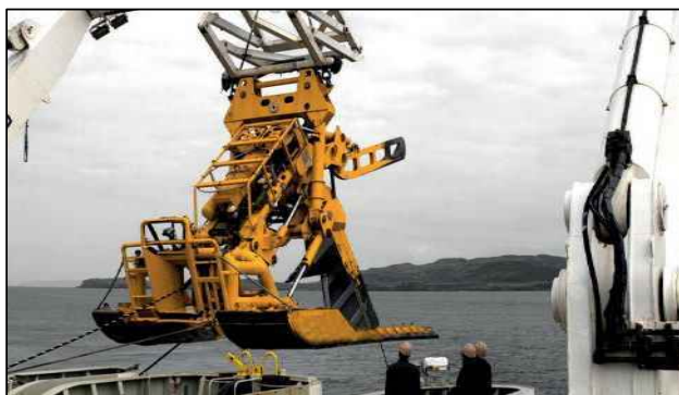
Figura 10.- Ejemplo de máquina de arado bajada en mar desde buque cablero. Fuente: NEC.
