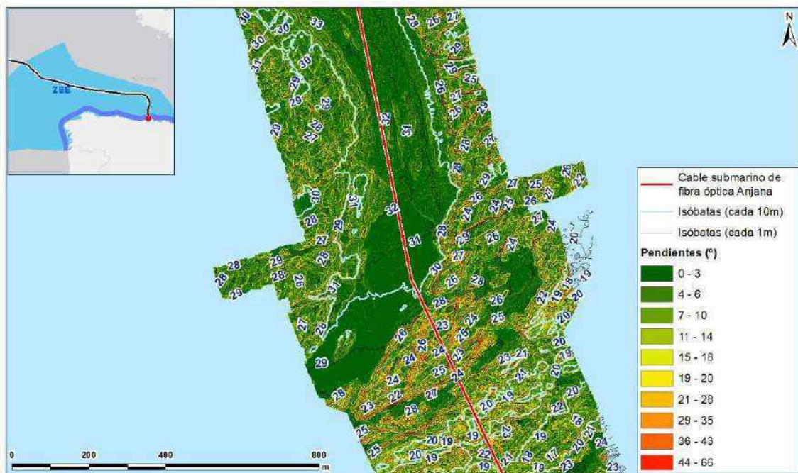
Figura 25.- Modelo de pendientes entre los 22 y los 31 m de profundidad. Fuente: elaboración propia a partir de datos de NEC.
