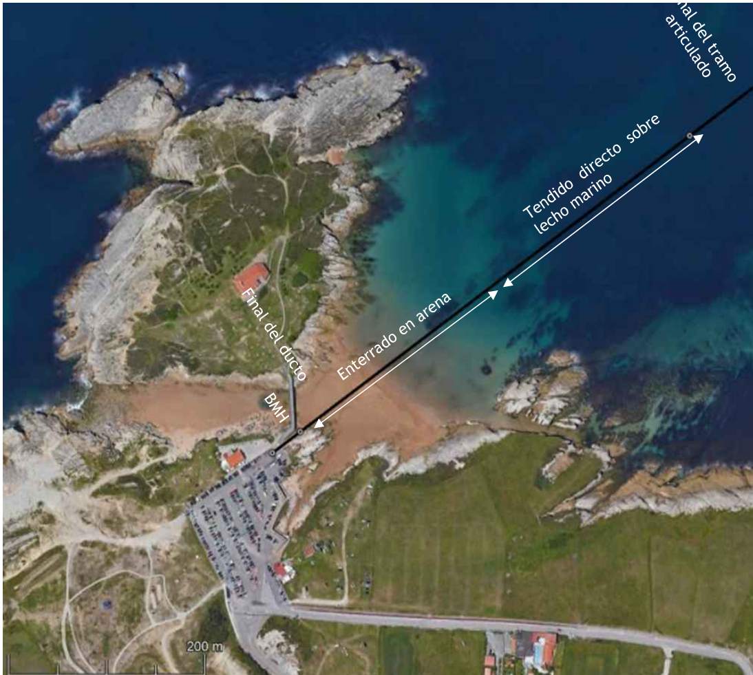
Figura 14. Tendido y protección del cable en la zona cercana a la costa. Fuente: NEC./Google Earth
