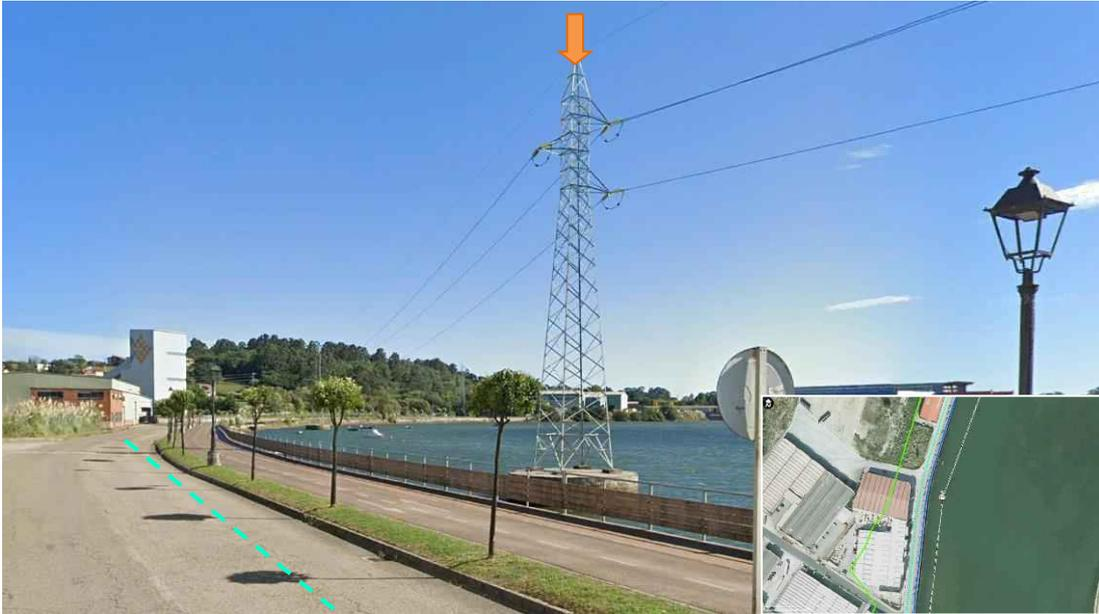
Figura 7.4.2.1. Ubicación de apoyo a desmantelar (flecha naranja) y trazado de la línea soterrada (línea discontinua azul, ambos dentro del DPMT).
