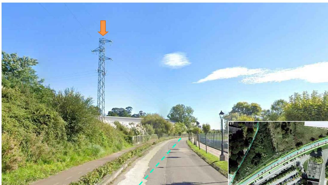
Figura 7.4.1.1. Ubicación de apoyo a dismantelar (flecha naranja) fuera del DPMT y trazado de la línea soterrada (línea discontinua azul) dentro del DPMT.
