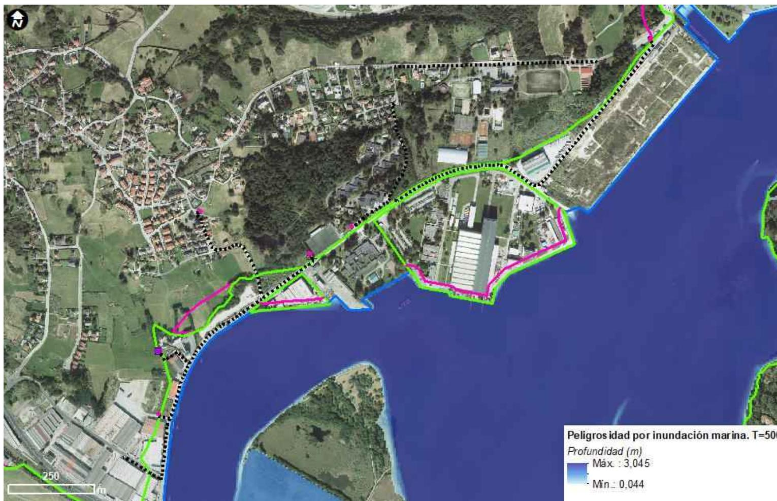
Figura 7.4.1.6. Simulación de la peligrosidad por inundación a 500 años de las infraestructuras proyectadas para el soterramiento de la LAT 12/20 kV Maliaño-Iris, situadas parcialmente sobre el dominio público marítimo-terrestre.
