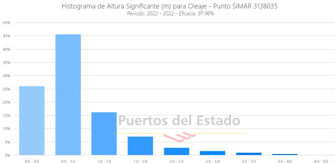
Figura 3.3.1.1. Punto SIMAR. Histograma Frecuencia Hs (Altura de Ola Significante) para el año 2022.
