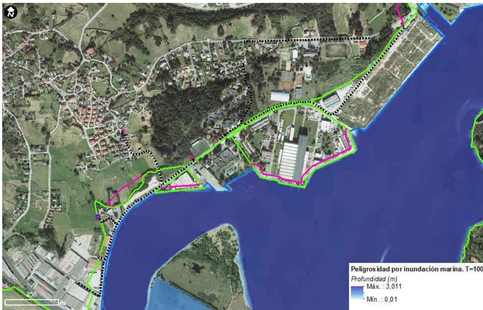
Figura 7.4.1.5. Simulación de la peligrosidad por inundación a 100 años de las infraestructuras proyectadas para el soterramiento de la LAT 12/20 kV Maliaño-Iris, situadas parcialmente sobre el dominio público marítimo-terrestre.
