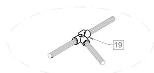
SOLDADURA ALUMINOTÉRMICA EN "T". CABLE CON CABLE.
