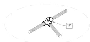
SOLDADURA ALUMINOTÉRMICA EN "T". CABLE CON CABLE.
