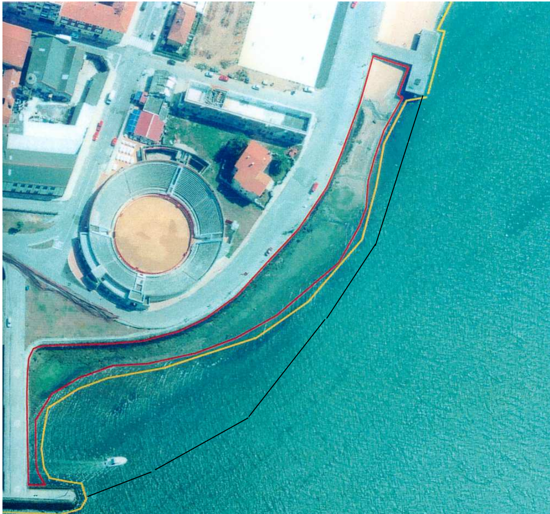
Fotografía 1. Situación de la zona de dragado, diferenciando la zona intermareal, línea roja, de la submareal, en amarillo
