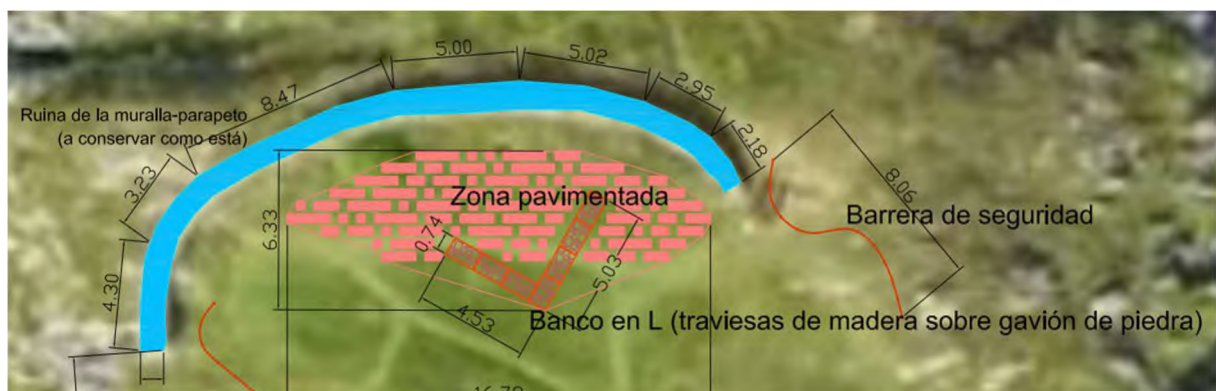
Ilustración 5: Detalle de la planta general acotada
