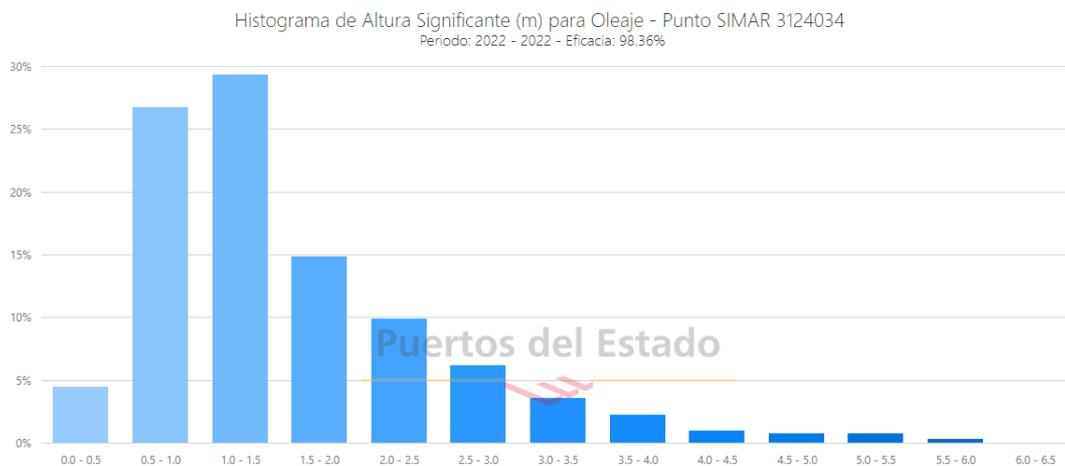
Figura 3.3.1.1. Punto SIMAR. Histograma Frecuencia Hs (Altura de Ola Significante) para el año 2022.
