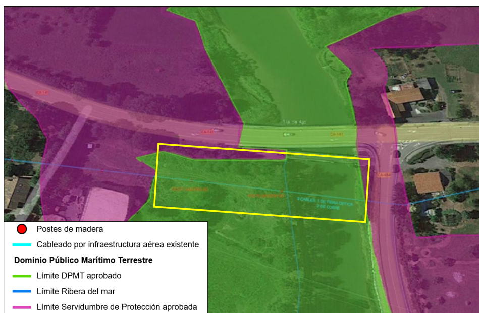
Ilustración 1. Límites del Dominio Público Marítimo Terrestre del ámbito de la instalación. Señalado con el cuadro amarillo la situación de los 2 postes de madera y cableado dentro de DPMT. (Fuente: Proyecto básico descriptivo. Telefónica de España, S.A.U. Año 2023).
