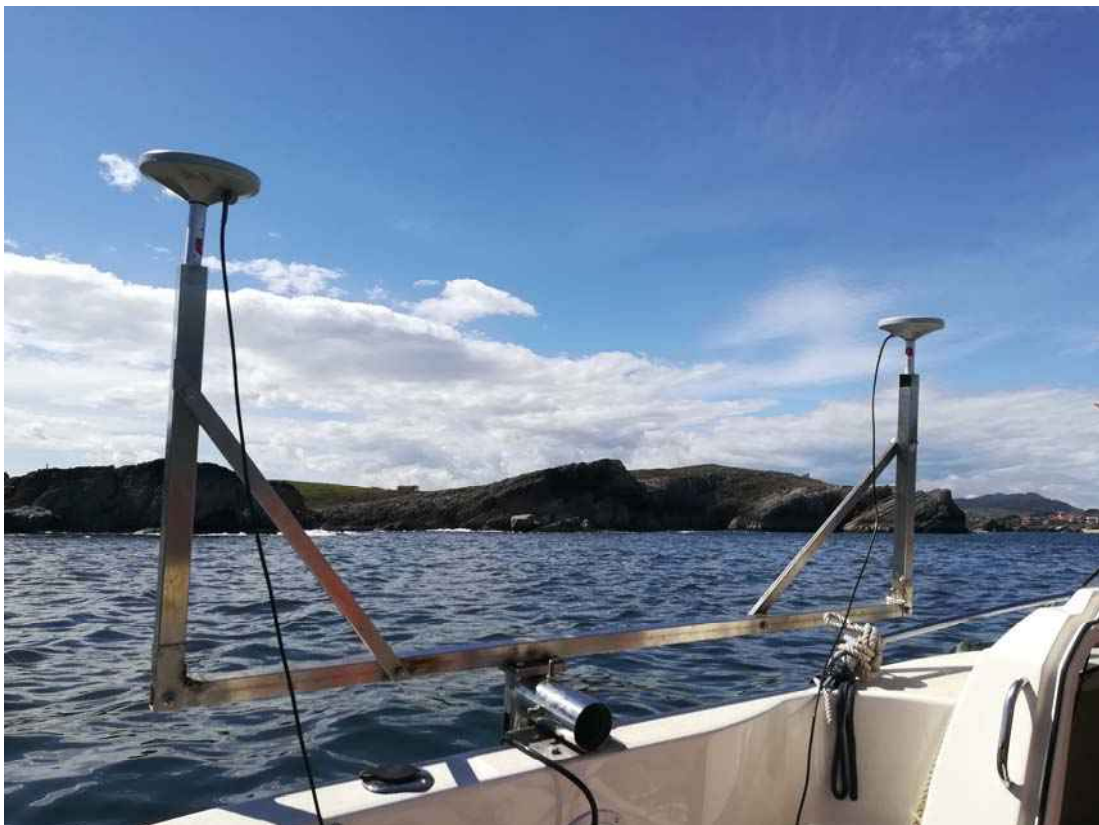
Antenas GPS RTK de posicionamiento UTM ETRS89 y rumbo
