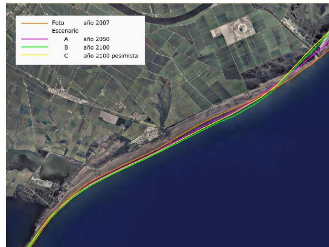
**Figura 3.** Líneas de costa actuales y de los diferentes escenarios de cambio climático en las playas de Eucaliptus, Migjorn y Serrallo. Fuente: Taller d'Enginyeries, 2008
