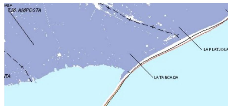
**Figura 6.** Previsión de las zonas inundables en el año 2100 considerando una altura de aumento del nivel del mar de 1m. Fuente: Taller d'Enginyeries, 2008
