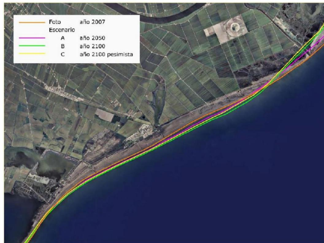
**Figura 9.** Líneas de costa actuales y de los diferentes escenarios de cambio climático en las playas de Eucaliptus, Migjorn y Serrallo. Fuente: Taller d'Enginyeries, 2008
