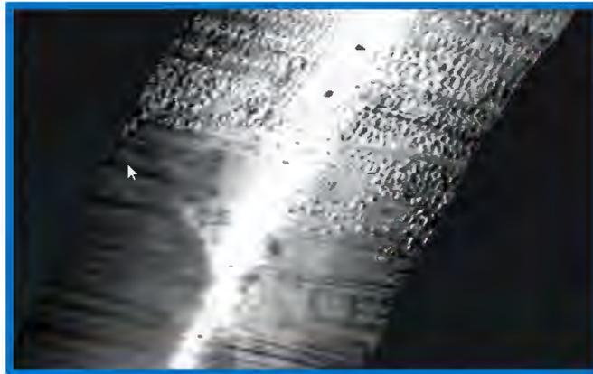
*Ejemplo de transición entre tipología de arenas superficiales y recubrimiento de Posidonia oceanica*
