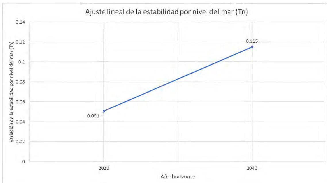
Gráfico 10. Ajuste lineal de la variación en el peso de las piezas de la obra de abrigo en función de la estabilidad por nivel del mar (Tn). Fuente: elaboración propia.
