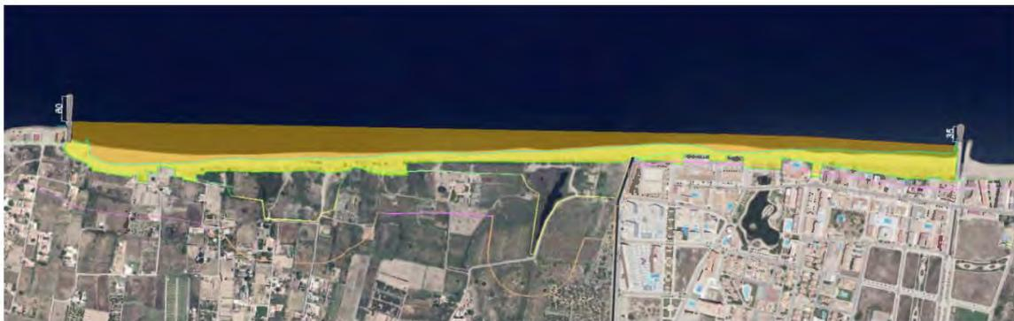
*Imagen 27. Forma en planta con la línea de costa regenerada para la Alternativa 4. Fuente: elaboración propia.*
