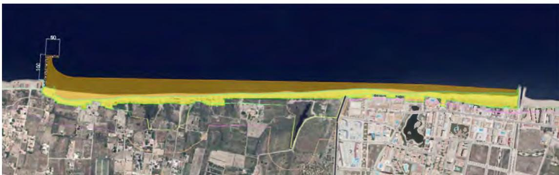
*Imagen 25. Forma en planta con la línea de costa regenerada para la Alternativa 2. Fuente: elaboración propia.*
