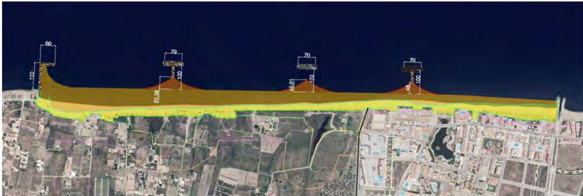
*Imagen 26. Forma en planta con la línea de costa regenerada para la Alternativa 3. Fuente: elaboración propia.*
