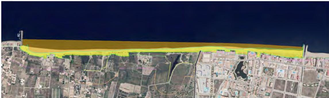
Imagen 23. Forma en planta con la línea de costa regenerada para la Alternativa 1. Fuente: elaboración propia.
