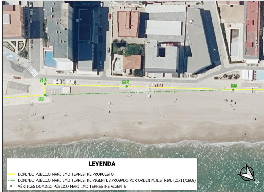
Figura 12. Detalle de la propuesta de modificación de la delimitación del DPMT entre los vértices M4 y M7.
