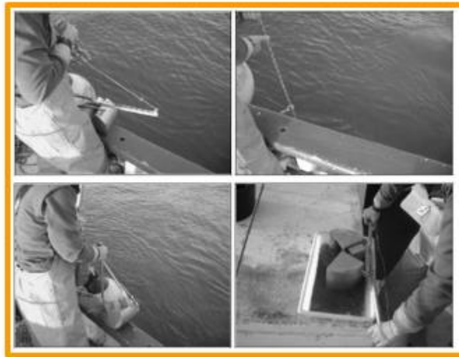
Toma de muestras mediante draga Van Veen
