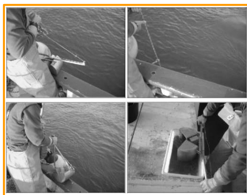
Proceso de toma de muestras mediante draga Van Veen
