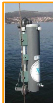
Botella oceanográfica. Izquierda: antes de ser “armada”. Centro: “armada” con tapas abiertas y preparada para inmersión. Derecha: botella recuperada tras lanzar el mensajero e izarla.
