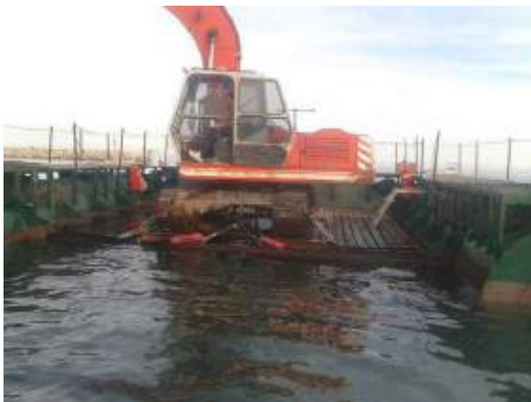
Retroexcavadora sobre pontona
