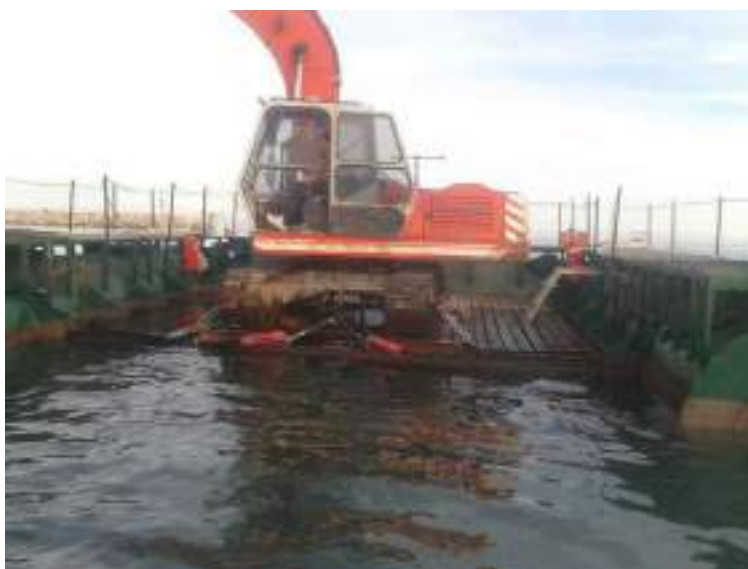
Retroexcavadora sobre pontona
