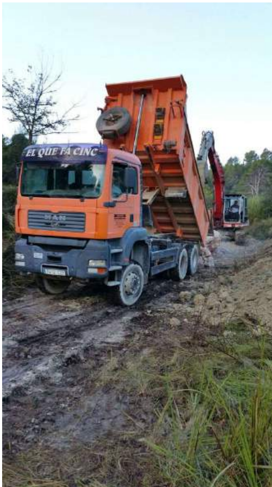
Camión bañera de 10 m3 tipo que se emplea en los transportes a zona de vertido.
