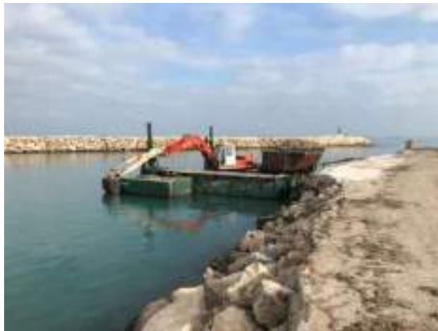
Retroexcavadora sobre pontona
