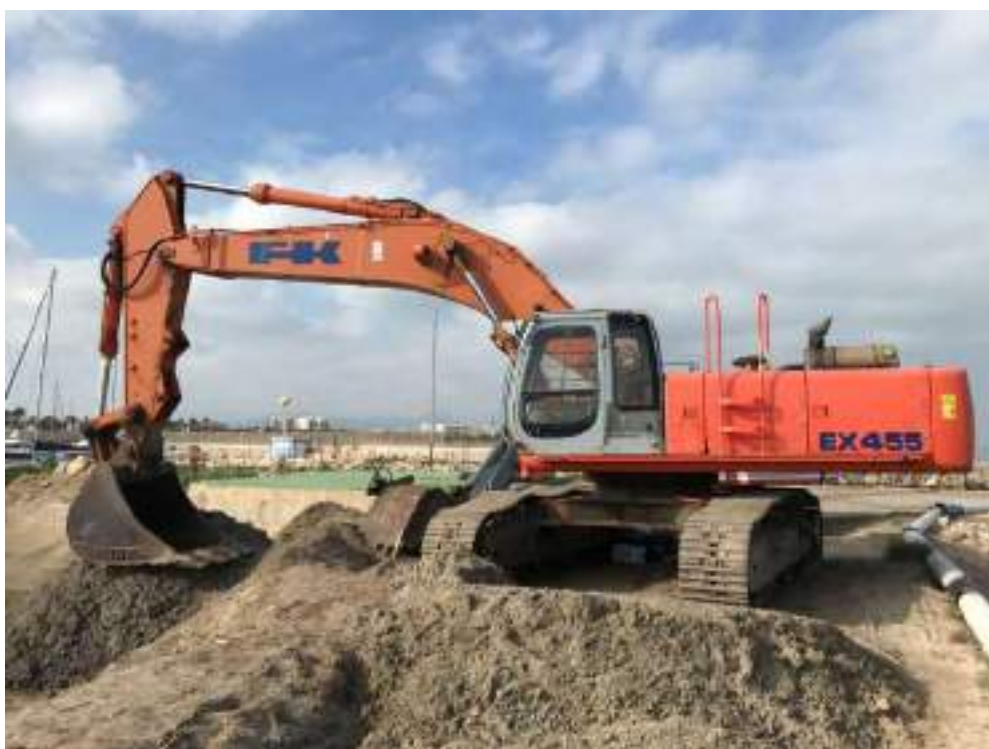
Máquina Retroexcavadora FK EX455 – Realiza trabajos de vaciado de Playeta y Balsa de decantación.
