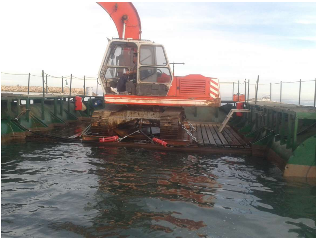
Retroexcavadora sobre base, flotadores y plataformas en la Pontona..
