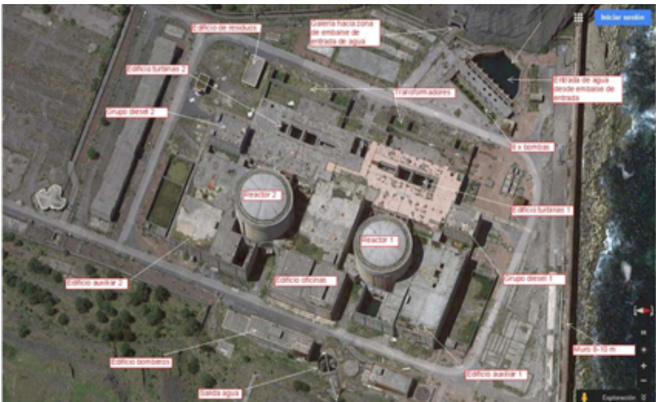
Figura 5. Estructuras de las ruinas de la ex central nuclear de Lemoiz.
