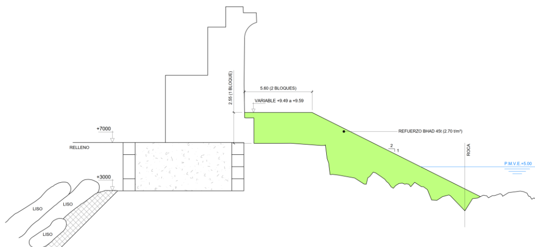
Sección Tipo Alternativa 2 – BHAD 45 t (2,70 t/m 3 ).
