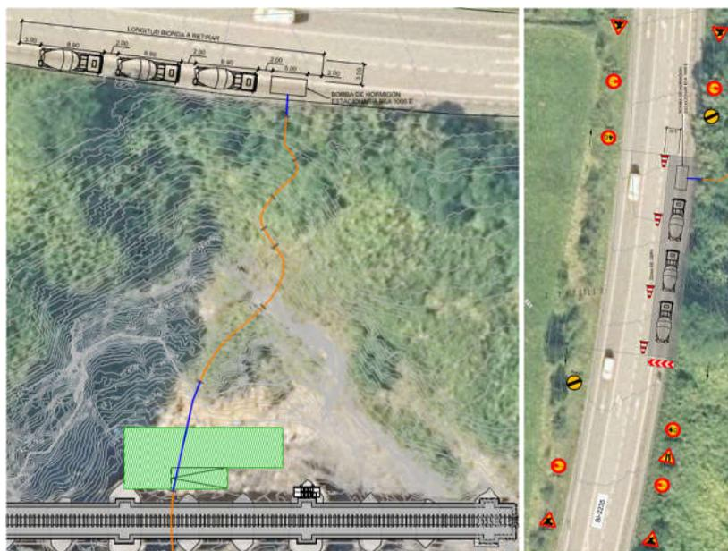
Figura 79. Tubo para hormigonado del dique y señalización BI-2235
