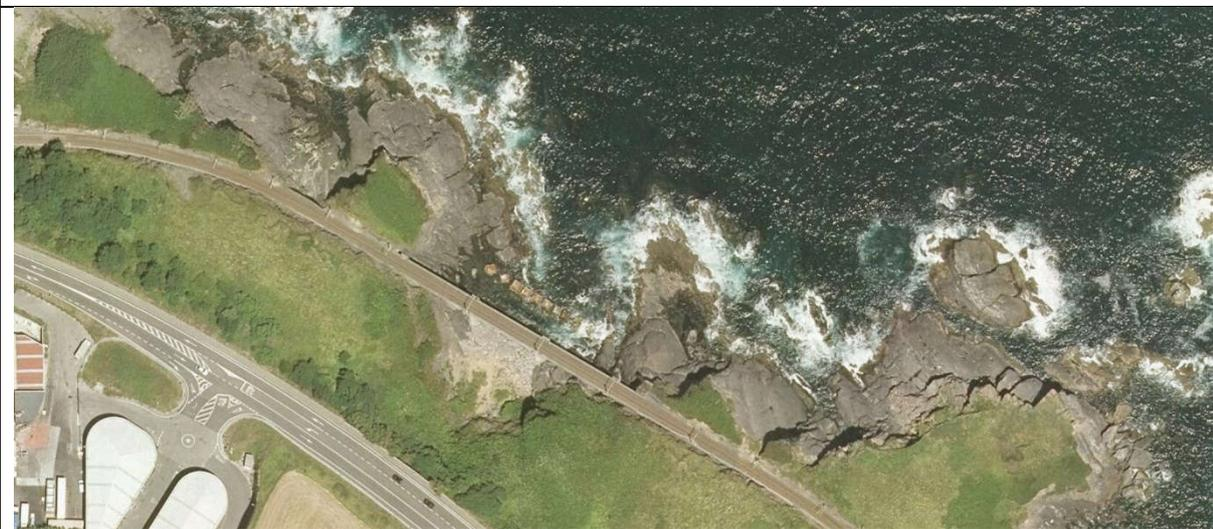
2016. Bloques de protección anclados al sustrato rocoso, pero con signos evidentes de deterioro. Se observa menor vegetación en la parte inferior de la ladera posiblemente causada por la incidencia de los temporales del año 2014.
