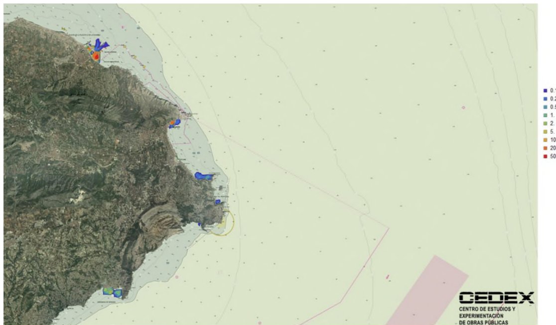
Figura 63. Densidad de fondeo en el cabo de San Antonio (Alicante) en 2018 (número de posiciones por km 2 , en tanto por uno con relación al número de instantáneas utilizadas) (Fuente: Elaboración propia a partir de datos AIS facilitados por SASEMAR).
