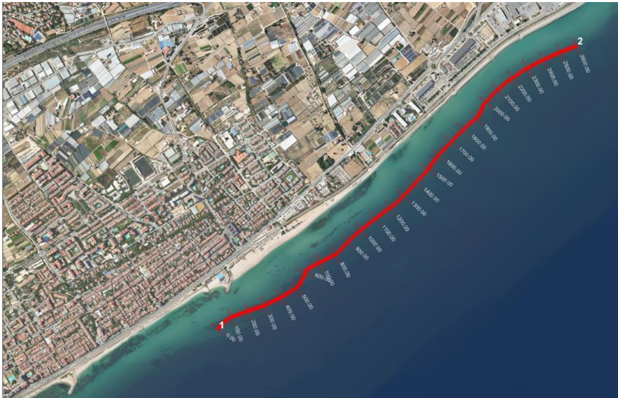
Figura 101. Perfil paralelo a la costa, sobre la batimétrica -6.00m
