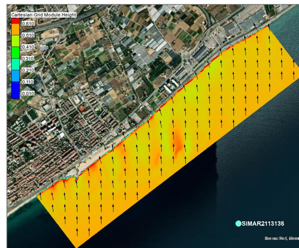
Figura 123. Propagación del oleaje del sector S en la malla de detalle
