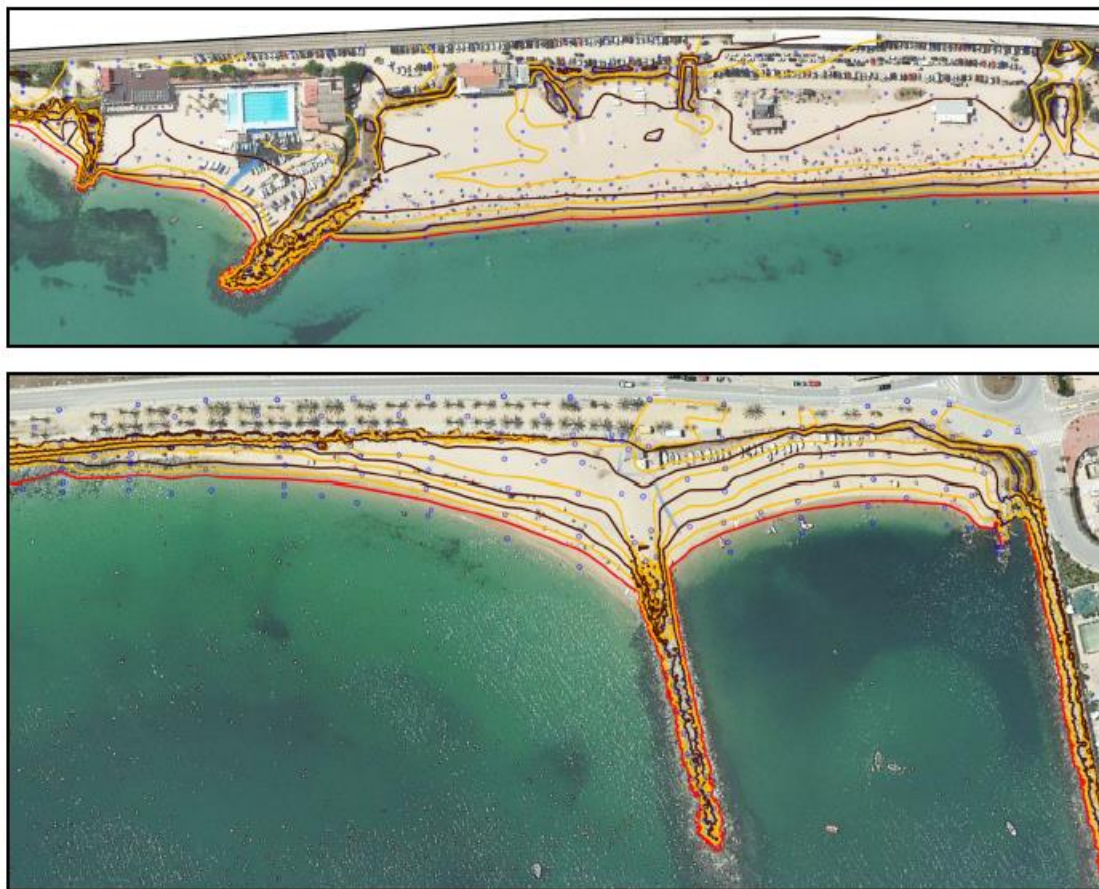
Figura 51. Curvas de nivel resultantes del levantamiento.
