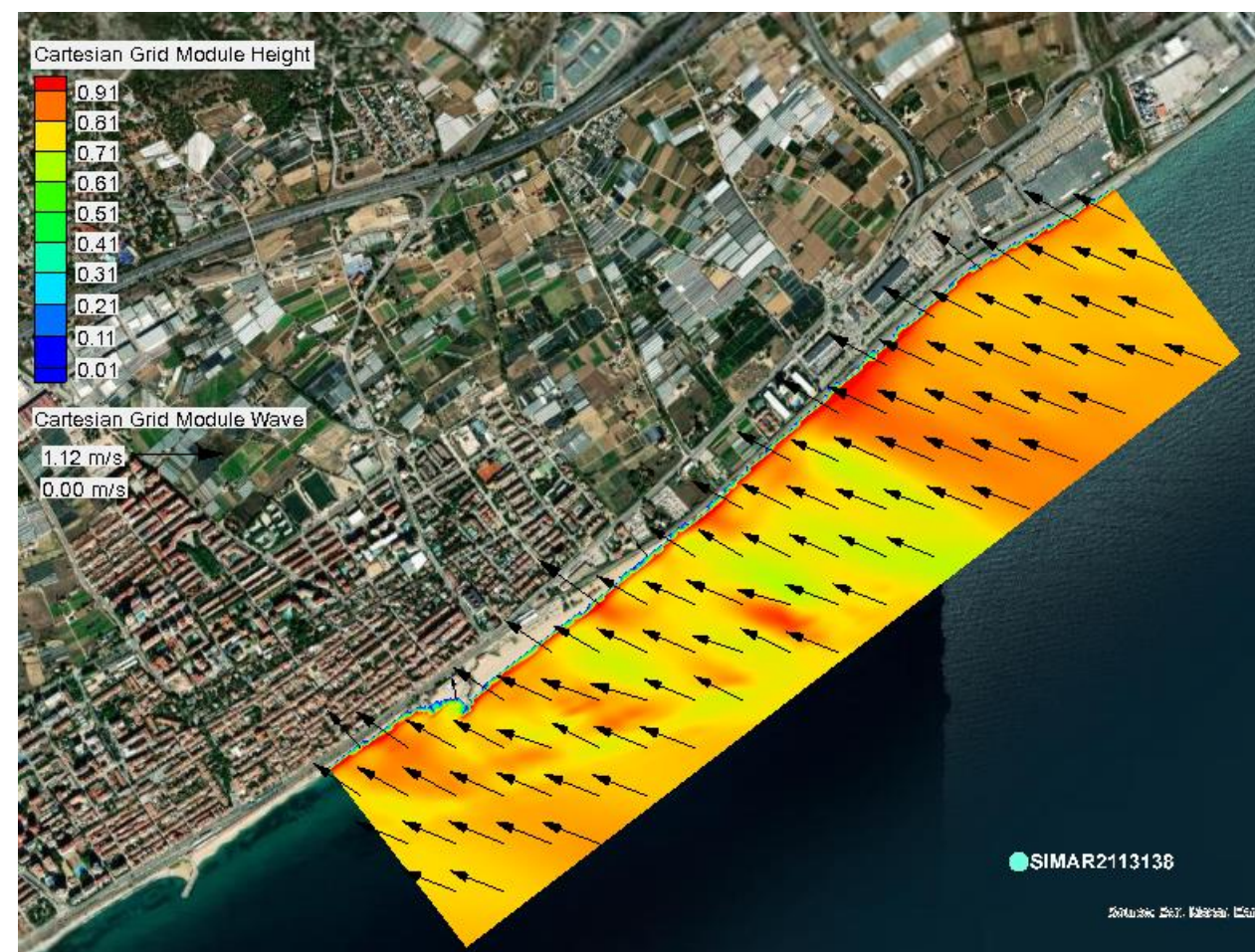
Figura 114. Propagación del oleaje del sector E en la malla de detalle
