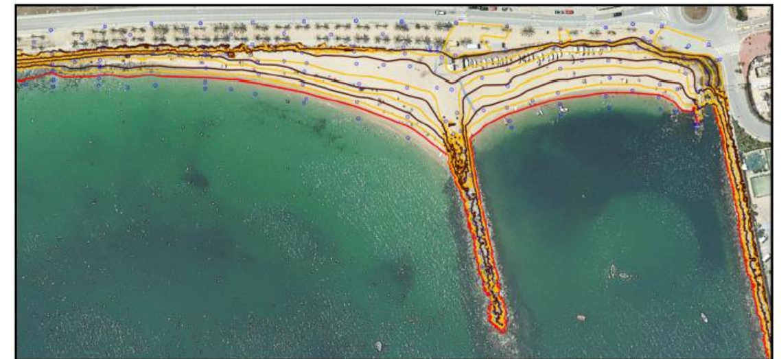
Figura 177. Curvas de nivel resultantes del levantamiento
