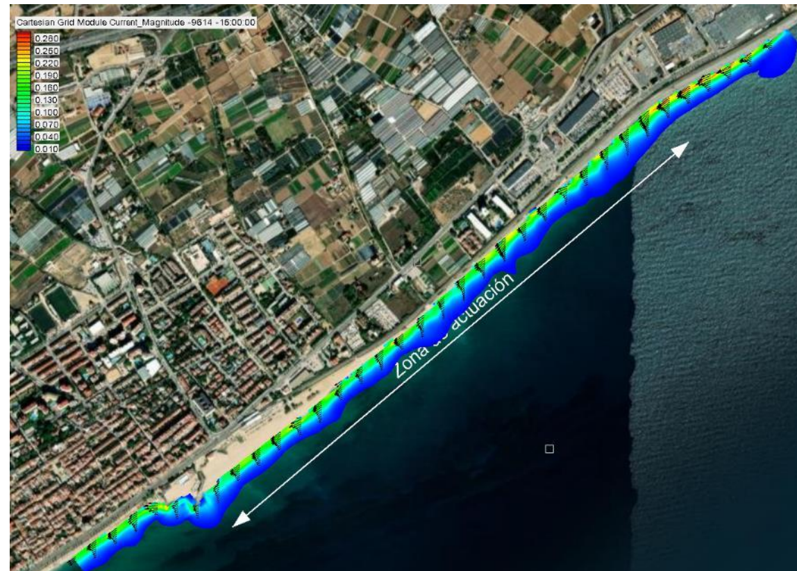
Figura 115. Corriente producida por la rotura del oleaje del sector E
