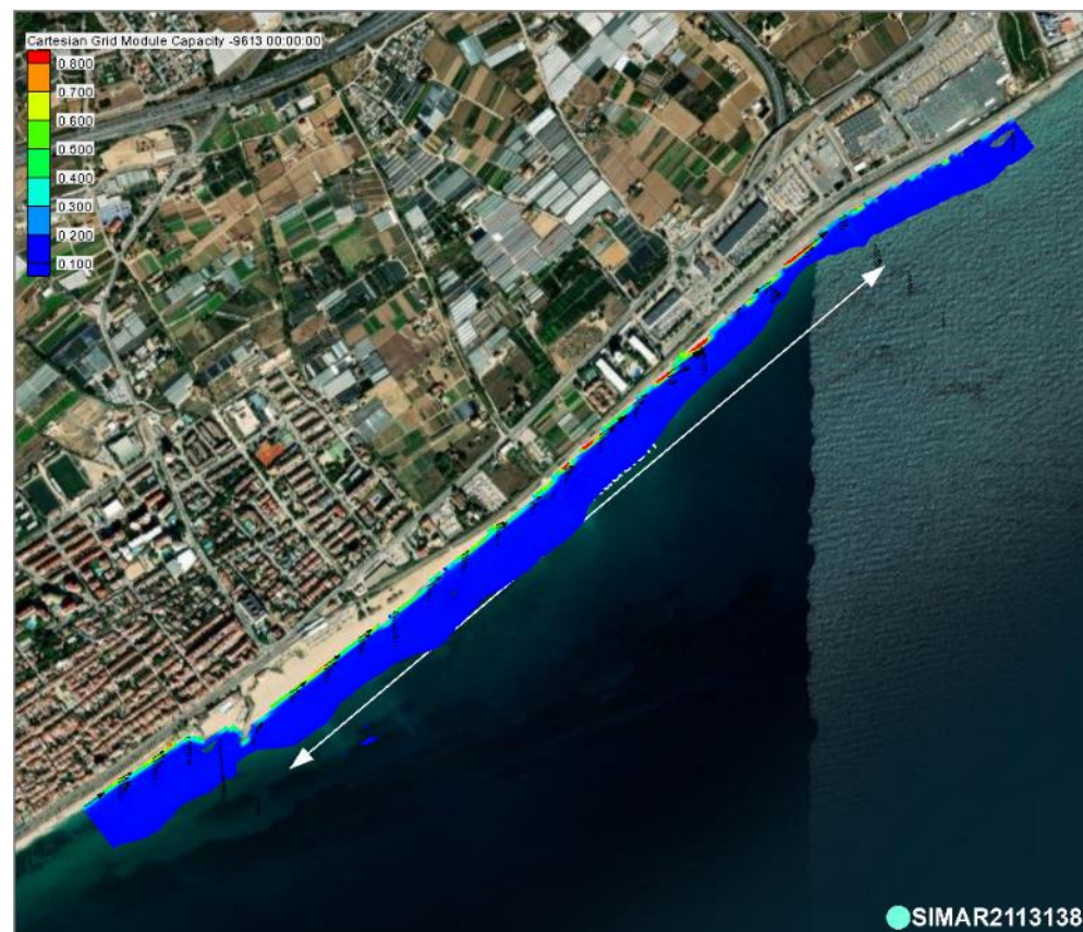
Figura 125. Potencial de transporte de sedimentos producido por el oleaje del sector S
