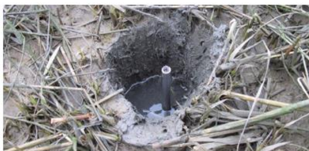
Figura 3. Introducción de las varillas con un martillo percutor. Durante la instalación se utilizan unos tableros de madera (Lynch et al., 2015).
