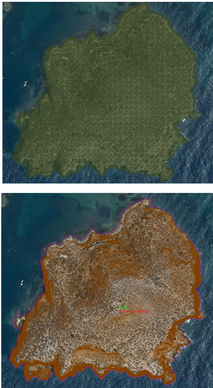
Ilustración 11: Mallado y curvas de nivel obtenido de resolución 0,5 x 0,5 metros (MDT 9, ZWCAD).
