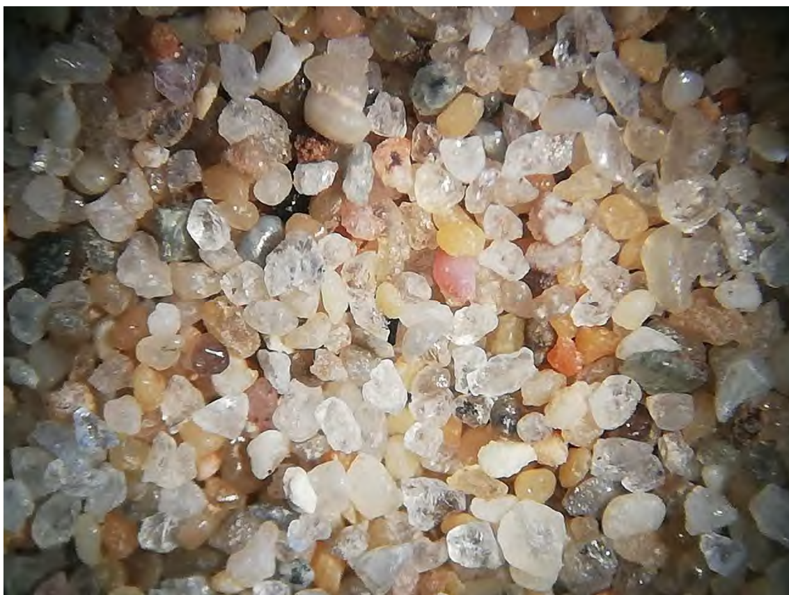
Fotografía nº 8: Calicata C-4 – 0,20-0,40 – Fracción Arena
