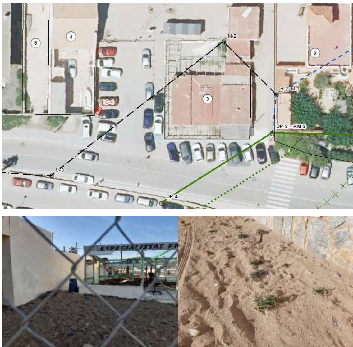
Figura 3. Imagen superior: Plano de deslinde de DPMT (línea verde y azul discontinua), ZMT (negra discontinua) y ubicación de calicata C-4 sobre ortofoto mapa del año 2022. Imagen inferior izquierda: Foto de detalle del mojón de ZMT M-2, junto a antiguo restaurante KATY antes de su demolición (año 2022), donde se observa la presencia de arena tras la línea de ZMT. Imagen inferior derecha: Foto de detalle de vegetación asociada a playas ( Cakile maritima ) junto a calicata C-4.
