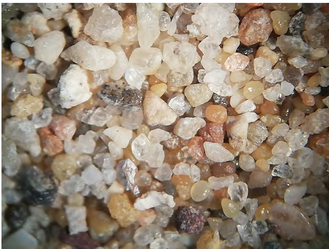
Fotografía nº 6: Calicata C-3 – 0,25-0,50 – Fracción Arena
