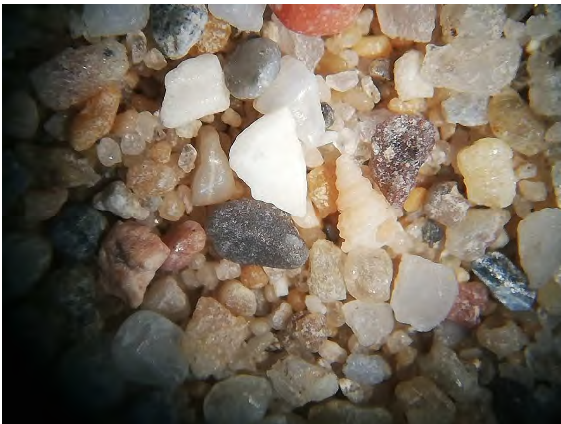
Fotografía nº 2: Calicata C-1 – 0,10-0,30 – Fracción Arena
