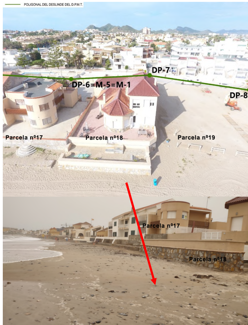
Figura.28. Imagen superior, fotografía aérea con la poligonal de DPMT y parcelas 17, 18 y 19 del proyecto de deslinde. Fuente Demarcación de Costas. Imagen inferior fotografía de fachada frente al mar de las parcelas objeto de estudio.
