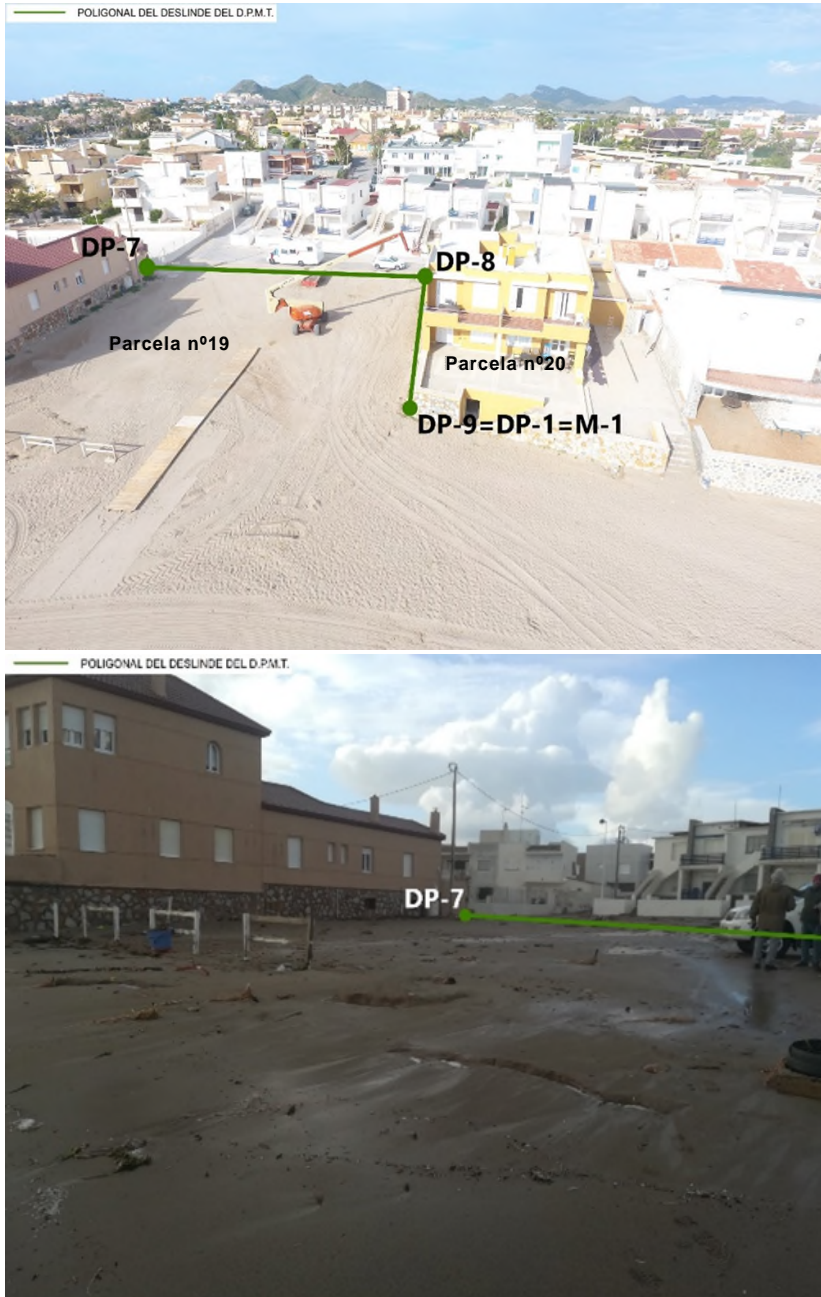
Figura.29. Imagen superior, fotografía aérea con la poligonal de DPMT y parcelas 19 y 20 del proyecto de deslinde. Imagen inferior fotografía de la parcela 19), que evidencia la influencia marina en la parcela (arena y restos de posidonia).
