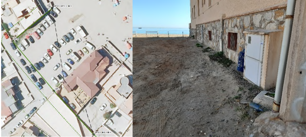
Figura 17. Plano de deslinde de DPMT (verde continuo) y ZMT (negro discontinuo) con posición calicata C-1, sobre ortofotomapa. Superior derecha: Mojón M-03 del deslinde de ZMT aprobado por OM 10/12/1959 en parcela 19. Inferior: Resultados calicata C-1.
