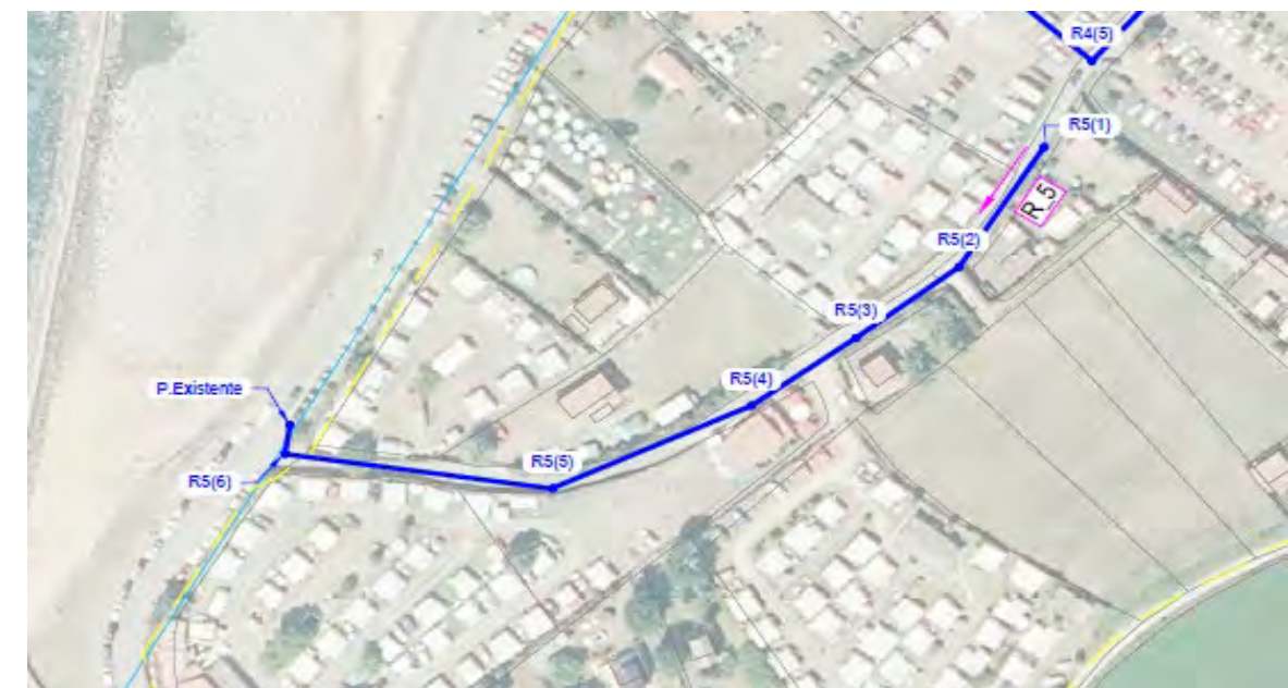
Figura nº 4. Conexión ramal R5 a pozo existente
