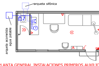
PLANTA GENERAL INSTALACIONES PRIMEROS AUXILIOS
