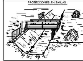
PROTECCIONES EN ZANJAS
