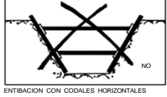
ENTIBACION CON CODALES HORIZONTALES
