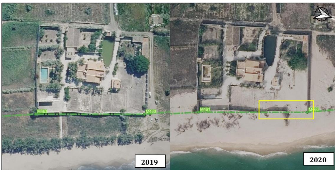
Figura 32. Muro perimetral en la zona sur de estudio en 2019 (izq.) y tras el temporal de 2020 (der.).
