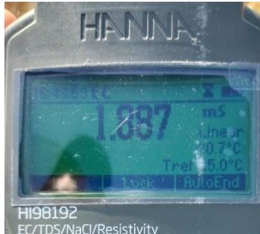
Figura 47. Fotografías de la toma y del resultado de la conductividad medida in situ de las muestra de agua.
