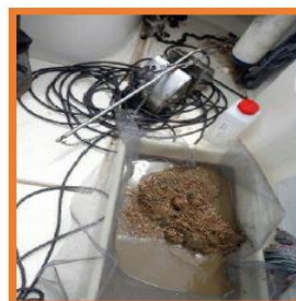
Imágenes del proceso de toma de muestras mediante draga Van Veen
