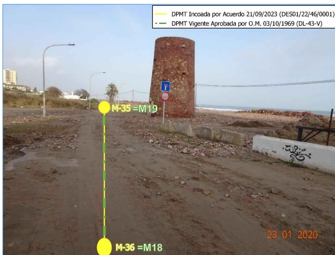
Figura 11.- Camino asfaltado cubierto de arena y restos procedente de la playa debido al temporal "Gloria" de enero de 2020, entre vértices incoados M-35 a M-36.
