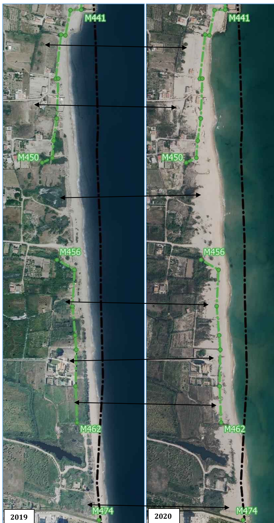
Figura 24. Zona de estudio en 2019 (izq.), y 2020 (dcha.) con la línea de deslinde vigente y señalando terrenos cubiertos con sedimentos arenosos arrastrados hacia el interior tras el temporal Gloria.
