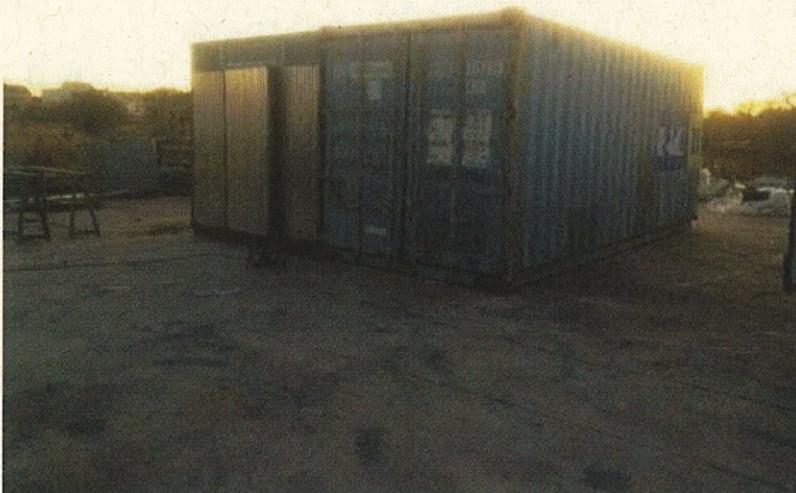
Se trata de un contenedor de 40 pies estándar, dividido en dos secciones idénticas, por lo que las medidas finales son: 6.10m de largo x 4,86m de ancho x 2,59 m. de alto.
