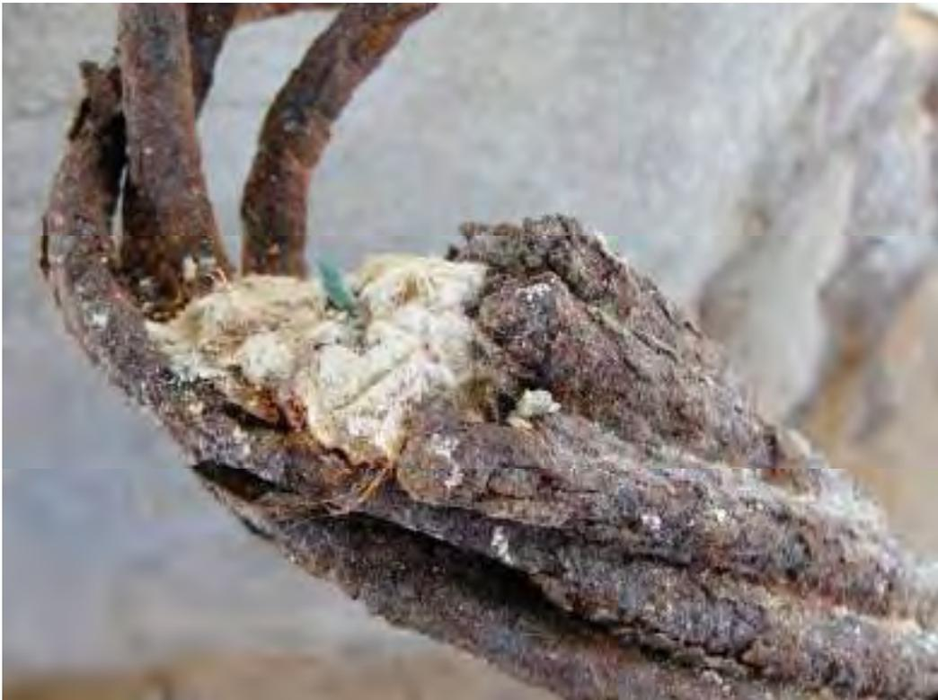
F.9. Detalle del cable, con el hilo conductor de cobre y las sucesivas capas de protección.
