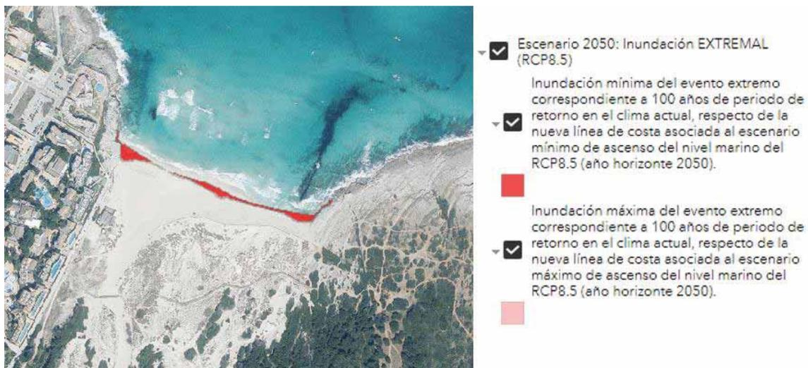
Ilustración 66. Zonas de inundación mínima y máxima extremal para evento de 100 años de periodo de retorno en escenario de nivel del mar RCP 8.5 en año horizonte 2050 en cala Mesquida (fuente: [https://ideib.caib.es/impactes\\_costa\\_canvi\\_climatic/](https://ideib.caib.es/impactes_costa_canvi_climatic/))
