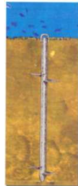
Figura 9. Anclaje tipo 'S'.
