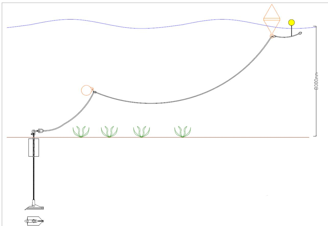
**Figura 3.** Ejemplo de un esquema de tren de fondeo con ancla JLD y boya intermedia
