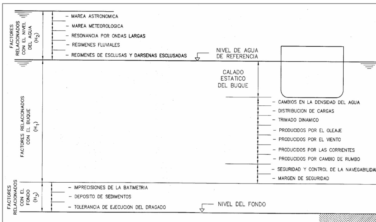
**Figura 9.** Factores que intervienen en la determinación de las profundidades de agua en las áreas de navegación y flotación. Fuente: R.O.M. 3.1-99
