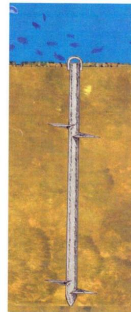
**Figura 10.** Anclaje tipo 'S'.
