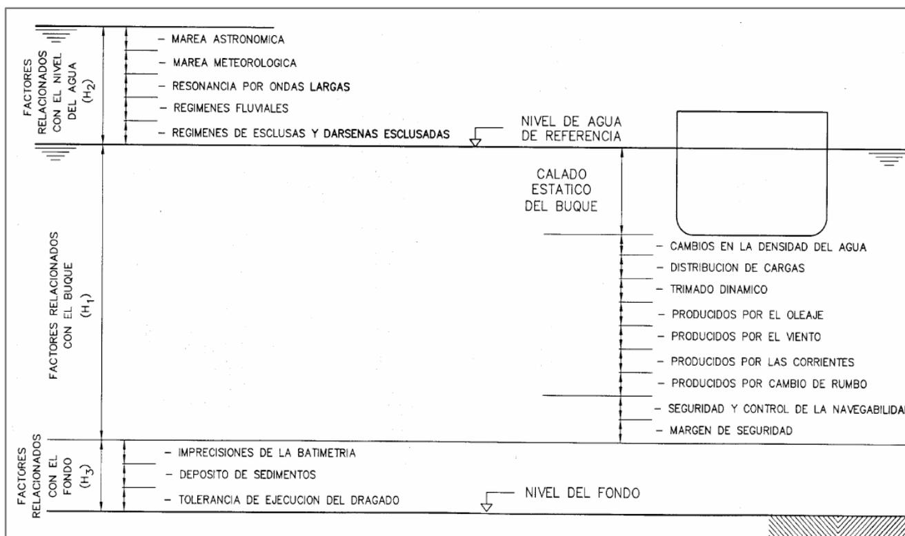
**Figura 5.** Factores que intervienen en la determinación de las profundidades de agua en las áreas de navegación y flotación. Fuente: R.O.M. 3.1-99
