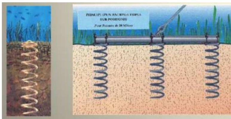
**Figura 11.** Anclaje tipo 'P'.
