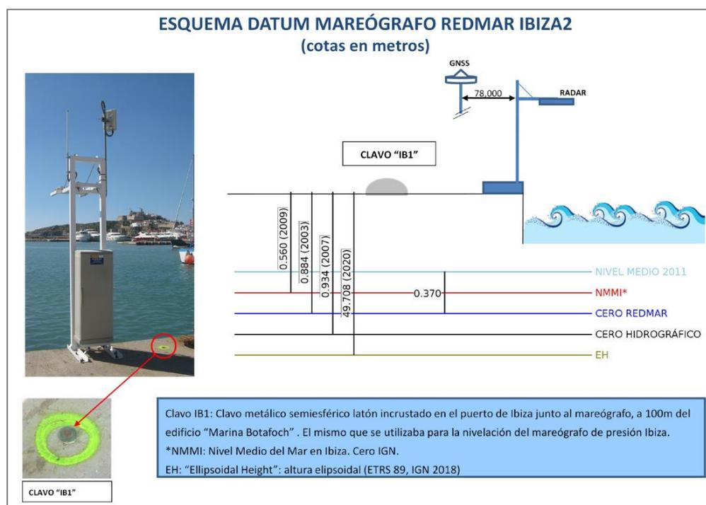
**Figura 5.** Esquema DATUM\* mareógrafo REDMAR Ibiza 2.
