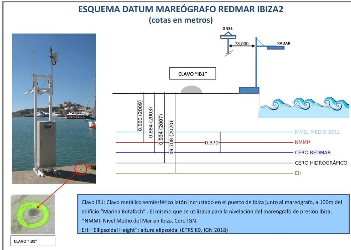
**Figura 6.** Posición relativa de las distintas referencias del sistema de coordenadas altimétricas para el mareógrafo de Ibiza 2.
