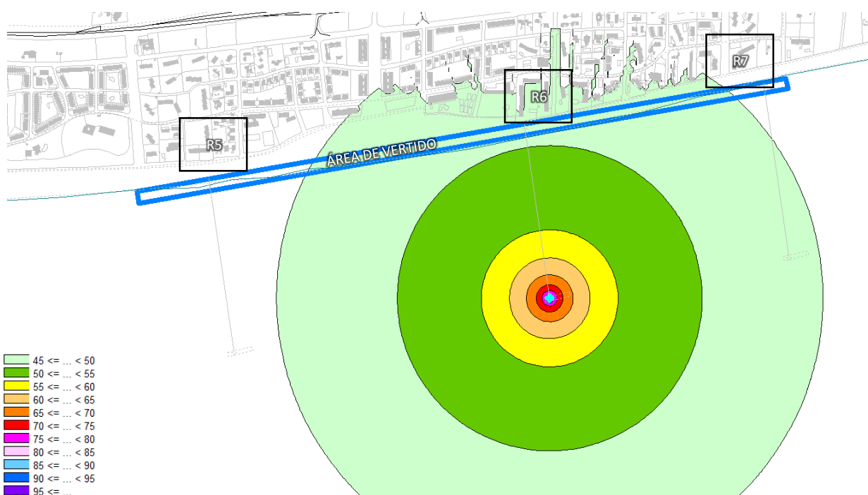
Figura 29. Nivel global de ruido nocturno, L_n (dBA), generado por la draga ubicada en la Posición 5, próximo al área de vertido
