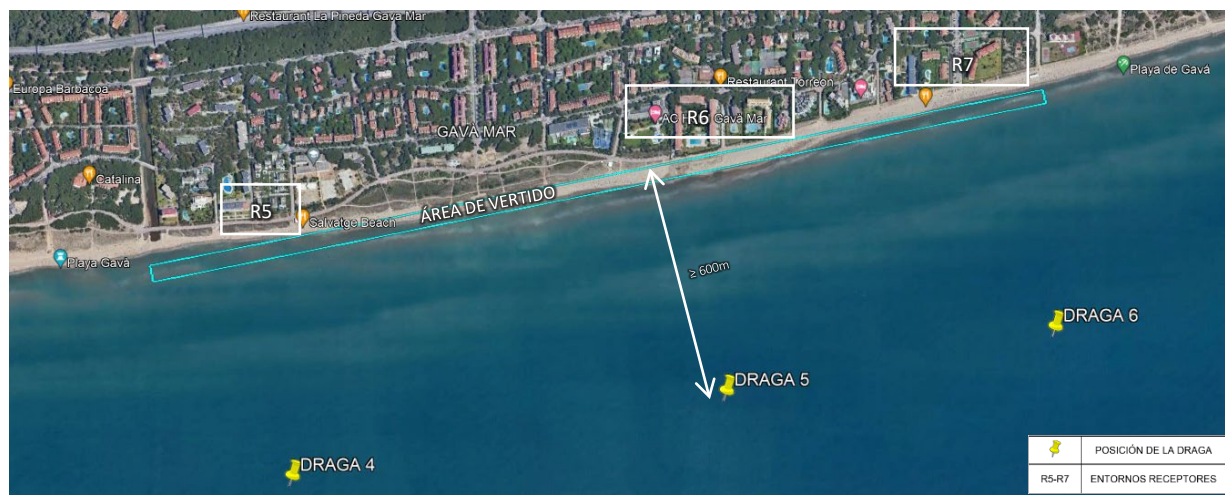
Figura 27. Posiciones de draga tomadas como referencia para el análisis acústico de las operaciones de vertido debido al bombeo de arenas desde la draga
