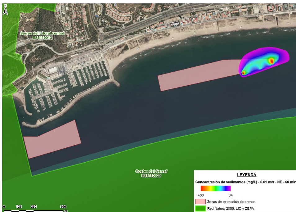
Figura 13. Caso 1. Concentración de sedimentos (mg/l) a los 60 minutos de iniciarse el dragado.
