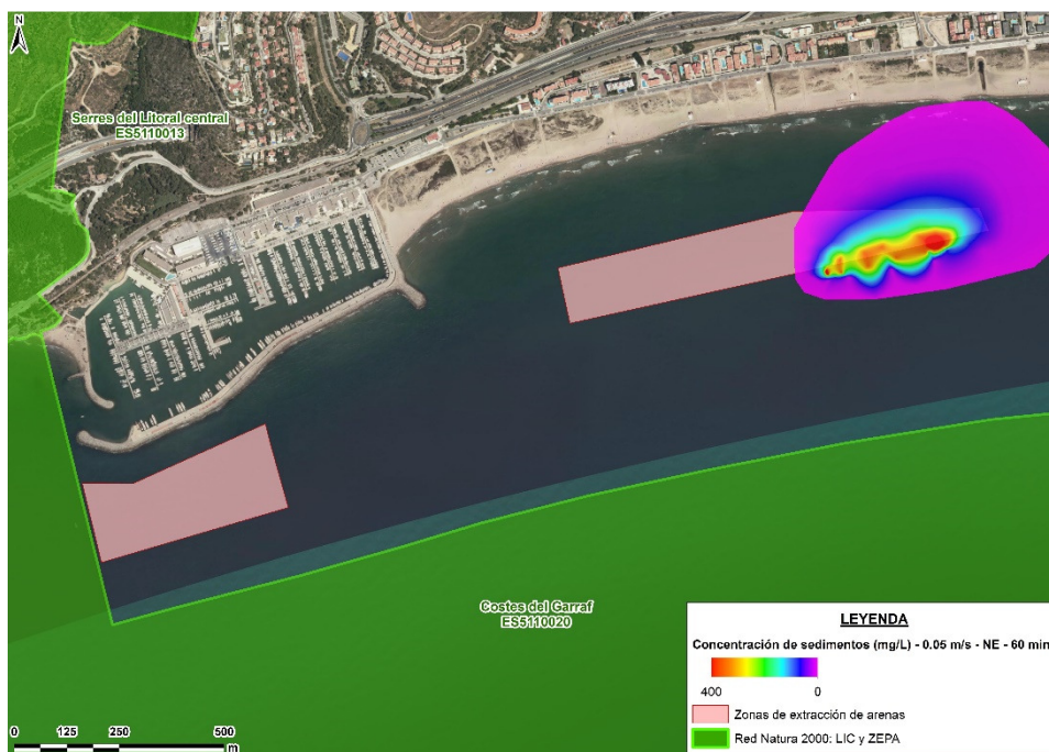
Figura 18. Caso 2. Concentración de sedimentos (mg/l) a los 60 minutos de iniciarse el dragado.
