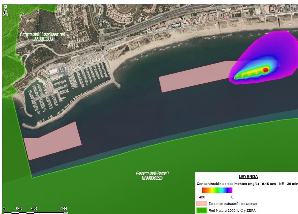
Figura 27. Caso 4. Concentración de sedimentos (mg/l) a los 30 minutos de iniciarse el dragado.
