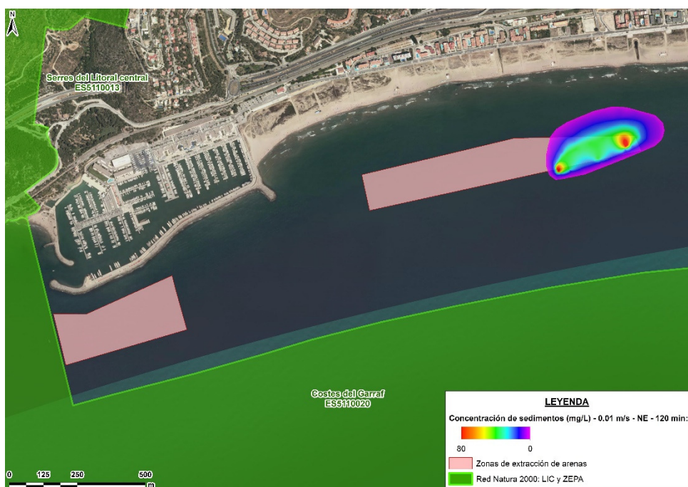
Figura 14. Caso 1. Concentración de sedimentos (mg/l) a las 2 horas de iniciarse el dragado.
