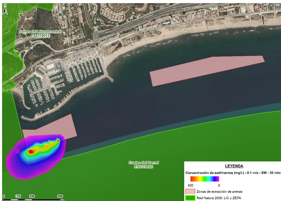
Figura 22. Caso 3. Concentración de sedimentos (mg/l) a los 30 minutos de iniciarse el dragado.
