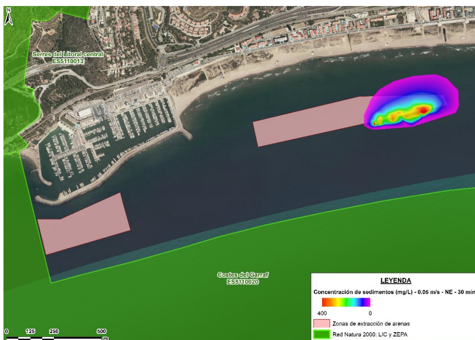
Figura 17. Caso 2. Concentración de sedimentos (mg/l) a los 30 minutos de iniciarse el dragado.
