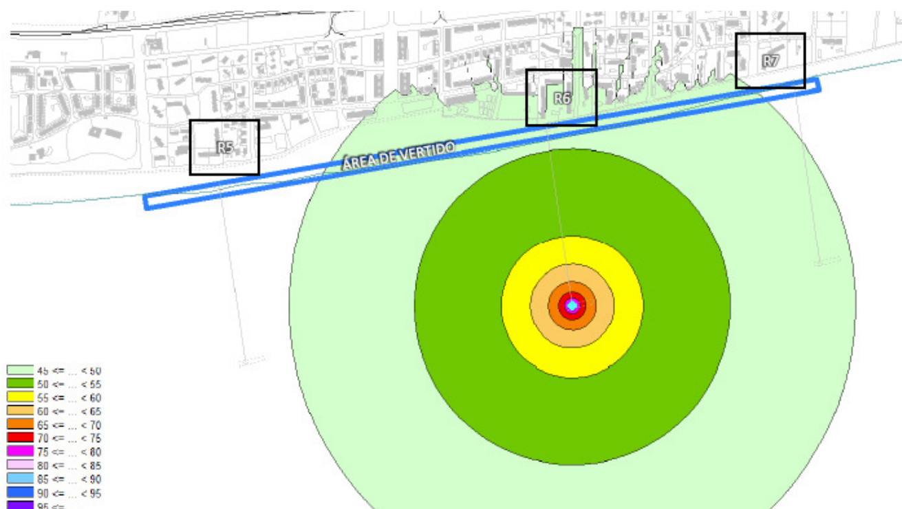
Figura 48. Nivel global de ruido nocturno, Ln (dBA), generado por la draga ubicada en la Posición 4, próximo al área de vertido.
