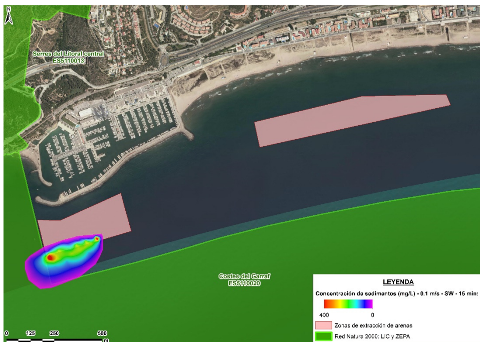
Figura 21. Caso 3. Concentración de sedimentos (mg/l) a los 15 minutos de iniciarse el dragado.
