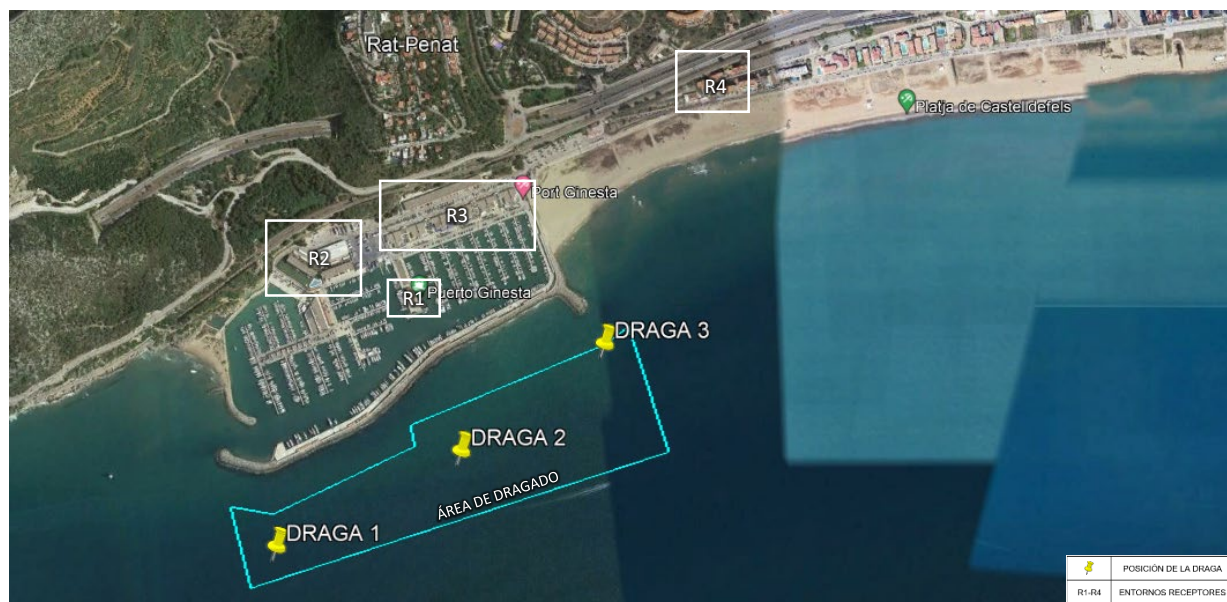
Figura 23. Posiciones de draga seleccionadas para el análisis acústico de las operaciones de dragado y entornos receptores de referencia
