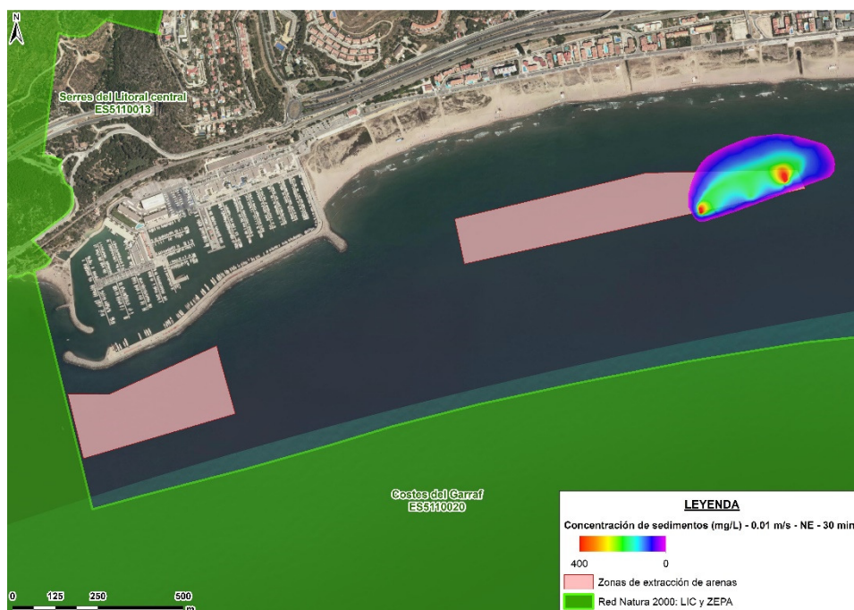
Figura 12. Caso 1. Concentración de sedimentos (mg/l) a los 30 minutos de iniciarse el dragado.
