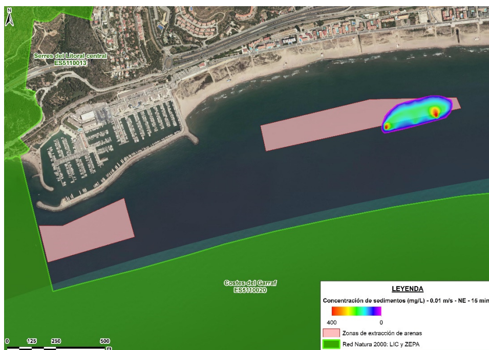
Figura 11. Caso 1. Concentración de sedimentos (mg/l) a los 15 minutos de iniciarse el dragado.
