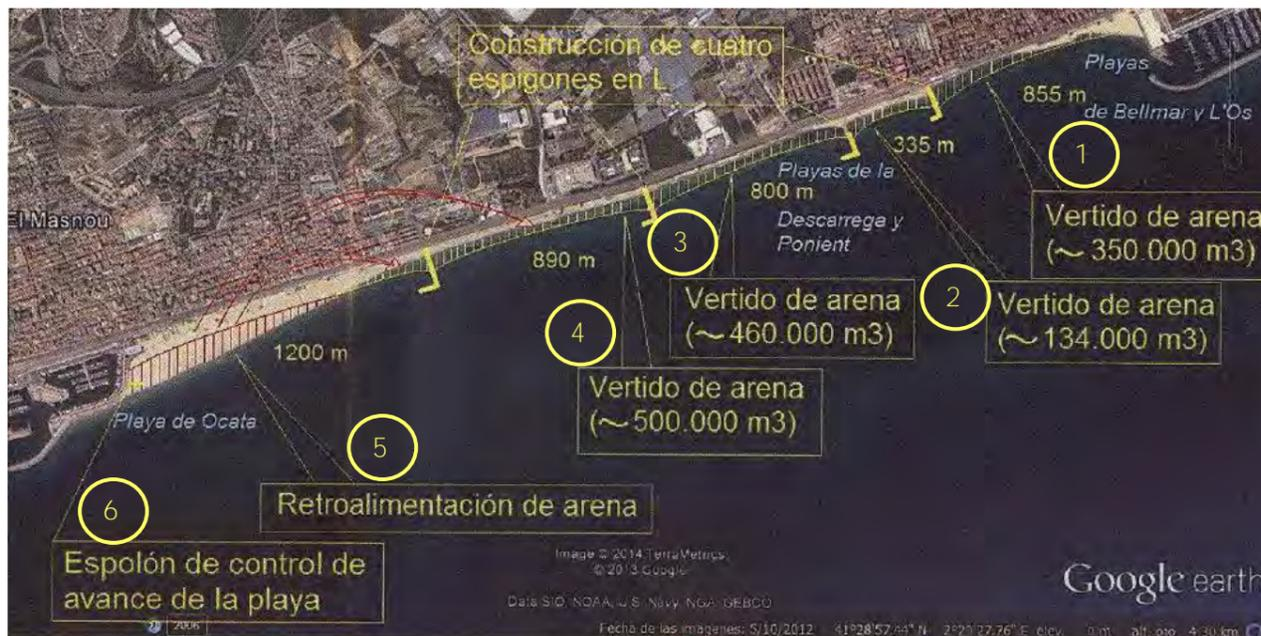
Figura 4.- Propuestas de actuación en el tramo entre los puertos de El Masnou y Premià sugeridas en el informe del CEDEX. (Fuente: CEDEX)
