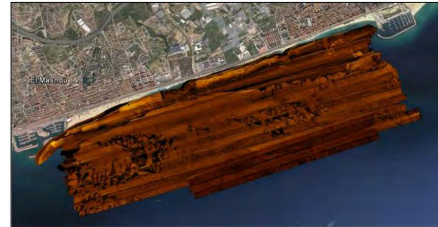
Figura 39.- Mosaico de los datos de sonar de barrido lateral en la zona de estudio (Fuente: Tecnoambiente)
