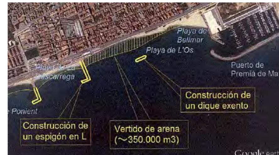
Figura 5.- Alternativa de la actuación 1 con espigón exento sugerida en dicho informe. (Fuente: CEDEX)
