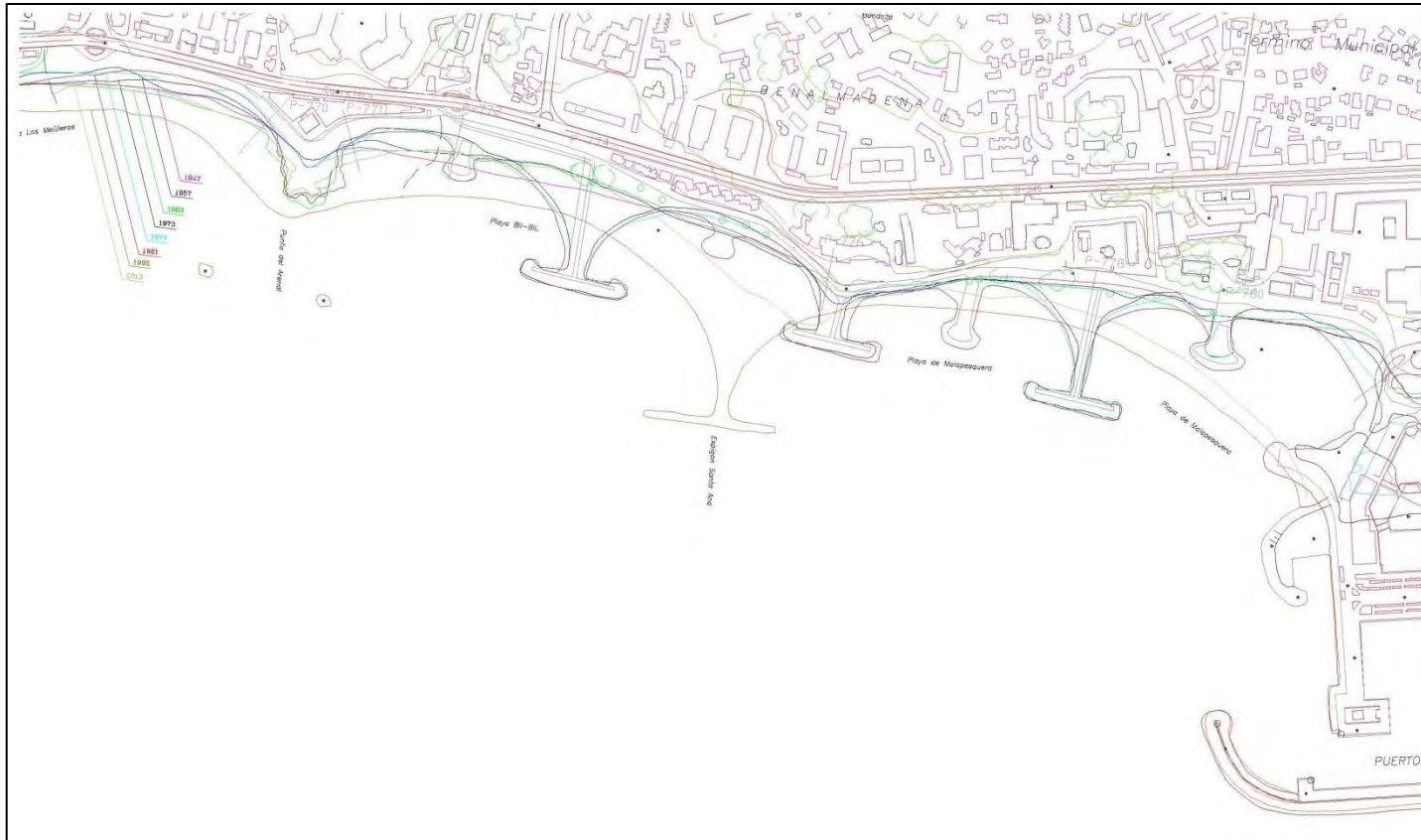
Ilustración 21. Evolución general de las líneas de orillas según evolución histórica de la sección litoral mediante análisis de imágenes satélites (1956-57 a 2014) Fuente: ACOPORT, proyecto de ampliación de dique exento entre las playas de Malapesquera y Santa Ana, T.M. de Benalmádena, 2015.
