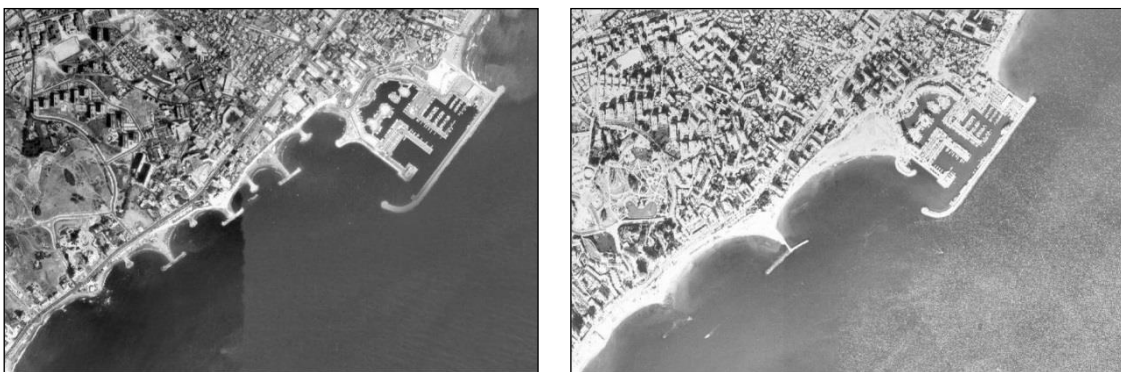
Ilustración 1. Fotografía aérea de los años 1984 y 1998, donde se puede ver el primitivo campo de espigones sustituido por un sistema de dos dique exentos
