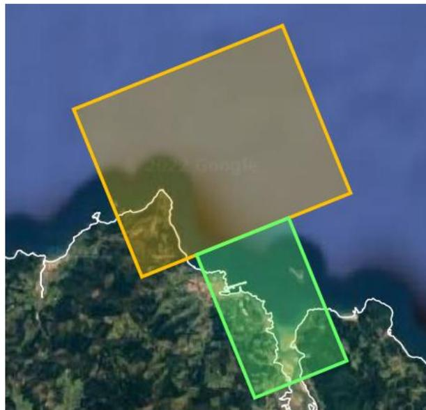
**Figura 15.** Mallas de propagación del modelo OLUCA. En amarillo: malla general. En verde: malla de detalle que contiene el puerto de Bermeo y el estuario inferior del Oka.
