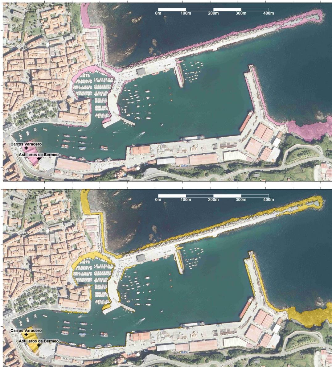
**Figura 46.** Superficie del puerto de Bermeo afectada por inundación. Arriba pueden verse los resultados del Escenario 3: Tr = 100 años, 2050, +26 cm; y abajo el Escenario 4: Tr = 500 años, 2050, +26 cm.
