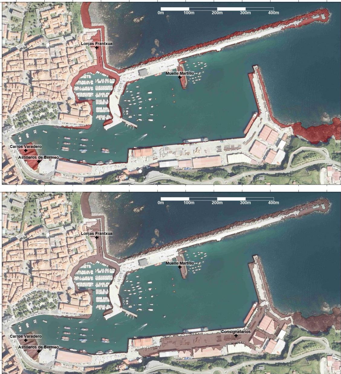
**Figura 47.** Superficie del puerto de Bermeo afectada por inundación. Arriba pueden verse los resultados Escenario 6: Tr = 100 años, 2100, +70 cm; y abajo el Escenario 8: Tr = 500 años, 2100, +70 cm.
