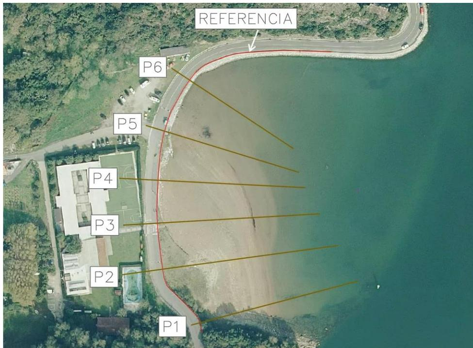
Imagen 6. Perfiles de control para la obtención de magnitudes correspondientes a la evolución histórica de la línea de costa en la zona de estudio. Análisis mediante imágenes obtenidas a partir de vuelos del IGN. Fuente: elaboración propia.
