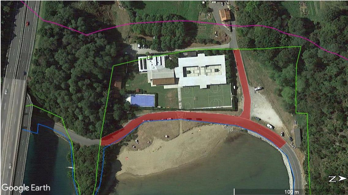
Imagen 3. Planta del vial de acceso al muelle. En rojo el tramo a demoler. Fuente: Google Earth y elaboración propia.
