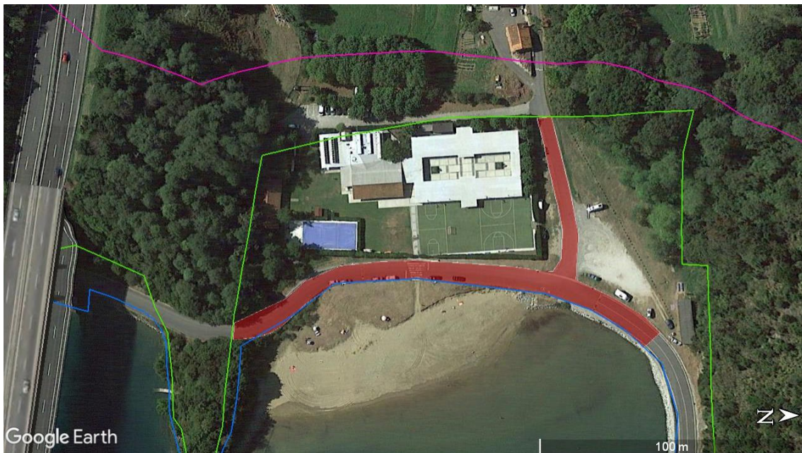
Imagen 43. Planta del vial de acceso al muelle. En rojo el tramo a demoler. Fuente: Google Earth y elaboración propia.
