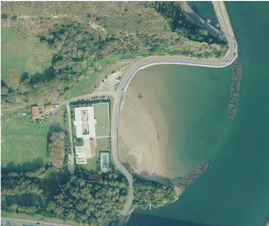
Imagen 58. Ubicación de los espigones proyectados en la alternativa marítima 2 para la playa de Orizarzar. Fuente: elaboración propia.
