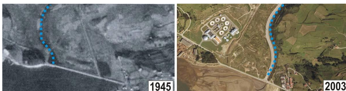
Figura 2. Fotografías aéreas de los años 1945 y 2003 donde se observa el desplazamiento de la desembocadura del arroyo Vioño (INDUROT 2009)
