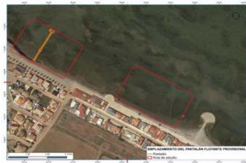
Estará formado por una pasarela quebrada de 24 m de longitud y 2 de ancho, seguido de un elemento intermedio de 6 m de longitud y 4 de ancho, en donde apoya. El pantalán flotante está formado por 3 elementos de 12 metros y 1 de siete, todos ellos de 2 m de ancho, y finalmente una plataforma flotante de superficie de 4 por 10 m con rampa en su extremo izquierdo para dar acceso a personas con movilidad reducida.
