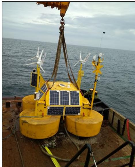
Figura 15. Configuración de izado de la boya. Fuente: EOLOS Floating LiDAR Solutions.
