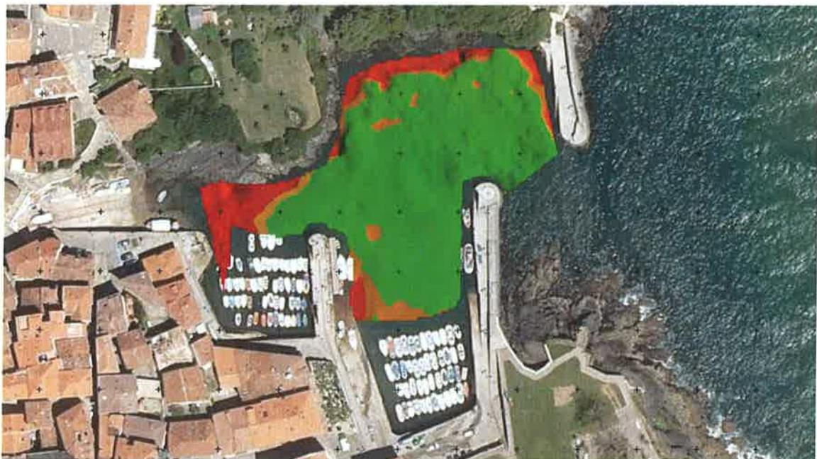
**Figuras 1 y 2.** Calados en el Puerto de Mundaka antes (mayo) y después (junio) de la realización del último dragado (2015). Rojo: no se alcanza el calado mínimo ( $-0,5\text{ m}$ ); naranja: no se llega al calado nominal ( $-1\text{ m}$ ); verde: se supera dicho calado nominal.
